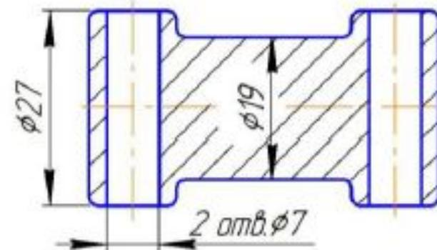
**12. При нанесении нескольких параллельных или concentрических размерных линий на небольшом расстоянии друг от друга *размерные числа* над ними рекомендуется *располагать в шахматном порядке.***
