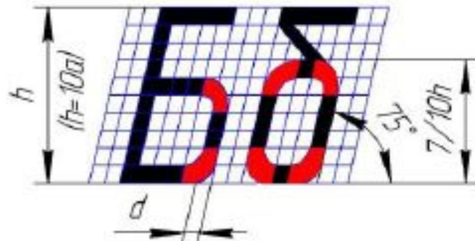
Размер шрифта определяется высотой  $h$  прописных букв (в мм).
