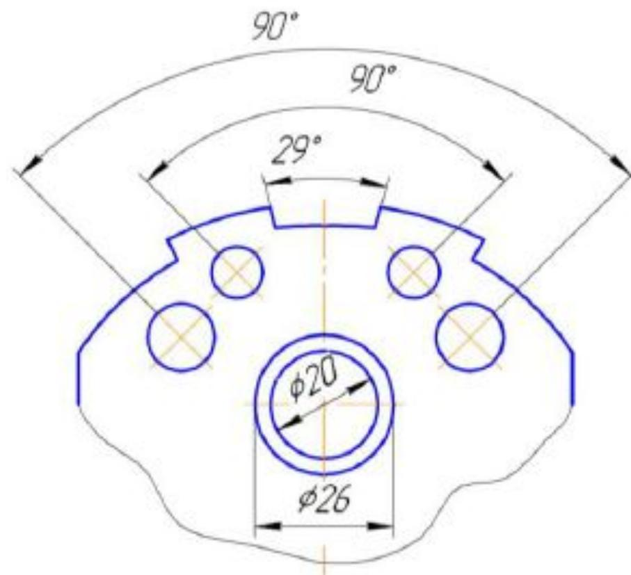
**13. Размерные числа линейных и угловых размеров при различных наклонах размерных линий. Если необходимо нанести размер в заштрихованной зоне, соответствующее размерное число наносят на полке линии-выноски.**
