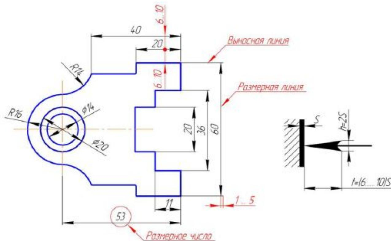
Нанесение размерных и выносных линий
