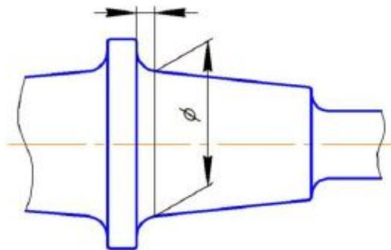
8. Если вид или разрез симметричного предмета или отдельных симметрично расположенных элементов изображают только до оси симметрии или с обрывом, то **размерные линии, относящиеся к этим элементам, проводят с обрывом, а обрыв размерной линии проводят дальше оси симметрии или линии обрыва детали.**
