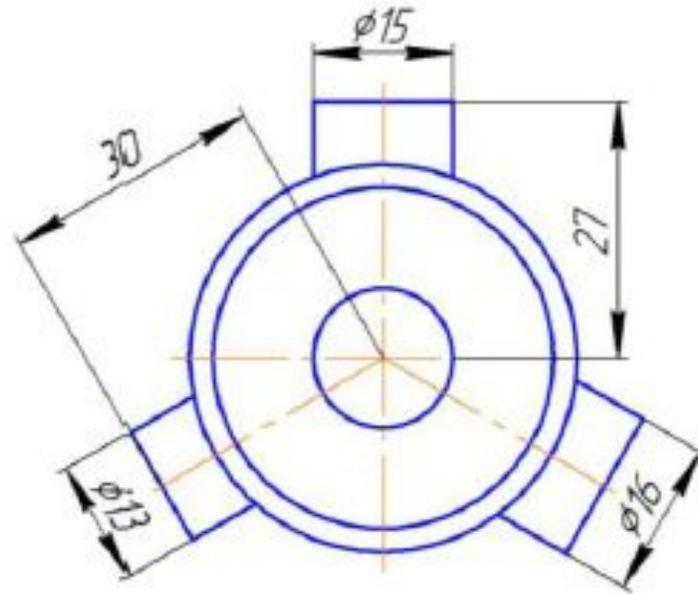
2. **Размерные линии, ограниченные стрелками, должны упираться в соответствующие линии видимого контура или в выносные и осевые линии. Размерные линии могут продолжаться за стрелки.**
