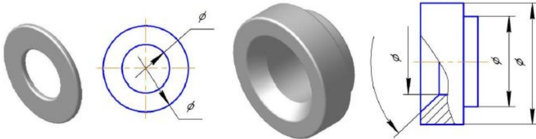
9. Для указания размерных чисел приняты арабские цифры. Цифры обычно пишут размером 3,5 мм, реже 5 мм. Как правило, **размерные числа наносят на расстоянии 1 мм от размерной линии на строчке, параллельной размерной линии и как можно ближе к ее середине.** Для размерных чисел применять простые дроби не допускается, за исключением размеров в дюймах.
