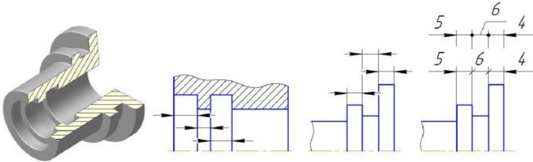
**4. Если изделие изображено с разрывом, то размерную линию не прерывают и наносят действительный размер. При нанесении размеров, определяющих расстояние между равномерно расположенными одинаковыми элементами изделия (например, отверстиями), рекомендуется вместо размерных цепей наносить размер между соседними элементами и размер между крайними элементами в виде произведения количества промежутков между элементами на размер промежутка.**
