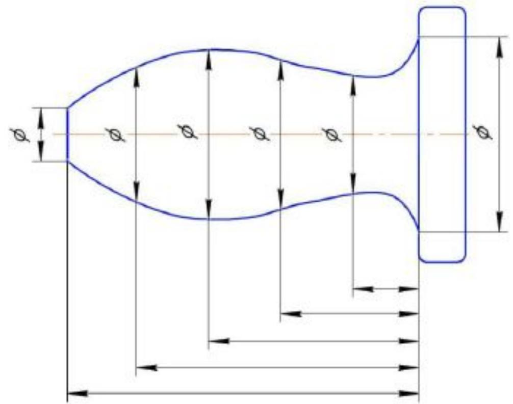
3. Если длина размерной линии недостаточна для выполнения на ней стрелок, то размерную линию продолжают за выносные линии, а стрелки направлены к наружной грани размеров.
