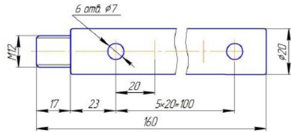
**5. При недостатке места для стрелки из-за близко расположенной контурной или выносной линии последняя допускается прерывать.**
