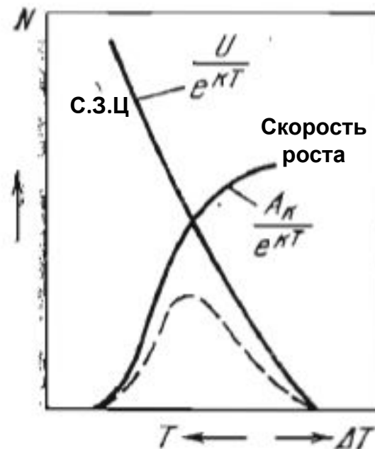
Рис. 25.53. Зависимость скорости зарождения центров ( N ) от степени переохлаждения ( \Delta T )
