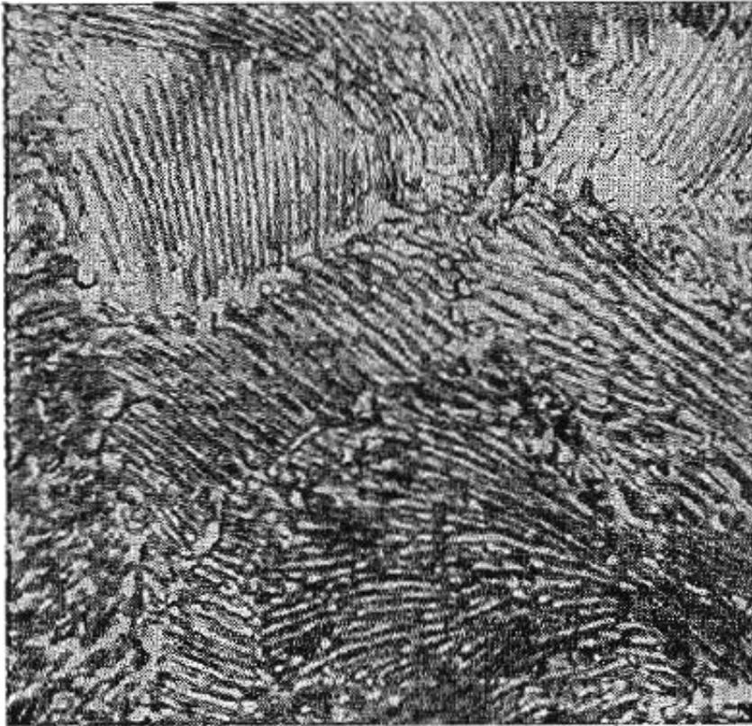
Рис. 25.46. Микроструктура перлита (сталь с 1 % C и 1,5 % Si).  $\times 1000$  (С. З. Некрасова)
