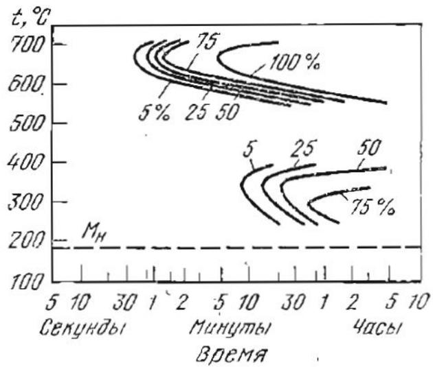
Рис. 25.50. Диаграмма изотермического превращения аустенита (сталь 70X3)
