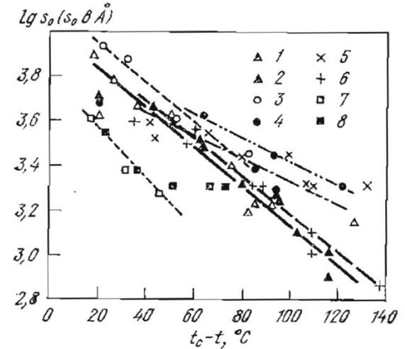
Рис. 25.49. Зависимость среднего межпластиночного расстояния перлита ( $s_0$ ) от переохлаждения ( $t_c - t$ ) для сталей различного состава [107]: 1 – 0,78 % C; 2 – 0,8 % C; 3 – 1,0 % Ni; 4 – 3,0 % Ni; 5 – 1,52 % Mn; 6 – 3,5 % Mn; 7 – 1,0 % Co; 8 – 2,0 % Co
