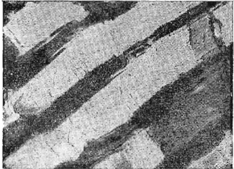
Рис. 25.47. Перлитный участок (сталь с 0,3 % C). Электронная микрофотография.  $\times 20000$  (Л. Г. Орлов)
