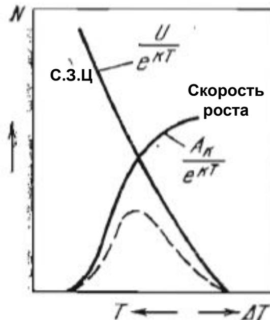
Рис. 25.53. Зависимость скорости зарождения центров ( $N$ ) от степени переохлаждения ( $\Delta T$ )
