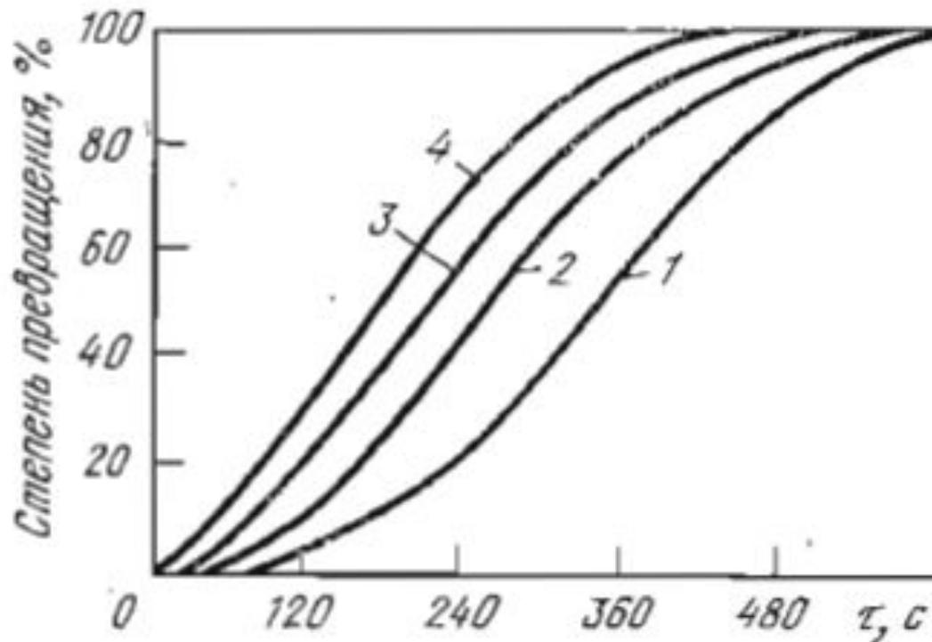
Рис. 25. 52. Влияние пластической деформации (при 800 °С) на кинетику перлитного превращения при 640 °С стали 40Х2Г2Р:
