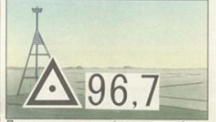
Пункты государственной геодезической сети на курганах (96,7 — высота над уровнем моря, 7 — высота кургана в метрах)
