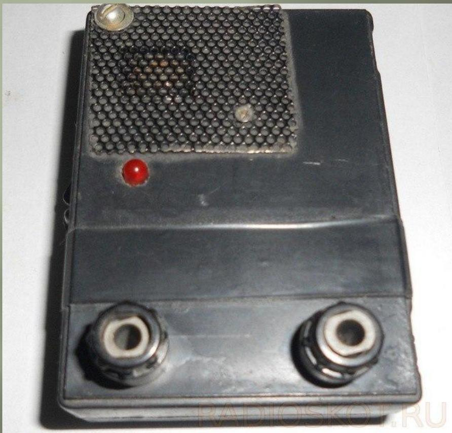
И в заключение о приведу фото и схему простейшего пробника, в корпусе маркера. Этот пробник пригодится в хозяйстве, если нет мультиметра, для прозвонки проводов, определения работоспособности предохранителей и тому подобных вещей.
