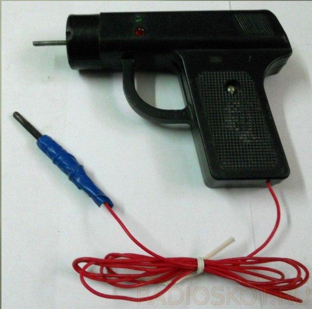
Третий вариант пробника, который может только прозванивать цепи, провода, дорожки на печатной плате, но не может использоваться, как индикатор напряжения, является Звуковой пробник, с дополнительной индикацией на светодиоде. Ниже приведена его принципиальная схема: этот прибор, также как и предыдущие позволяет прозванивать цепи, катушки, трансформаторы и резисторы с сопротивлением до 600 Ом, чего бывает достаточно в большинстве случаев
