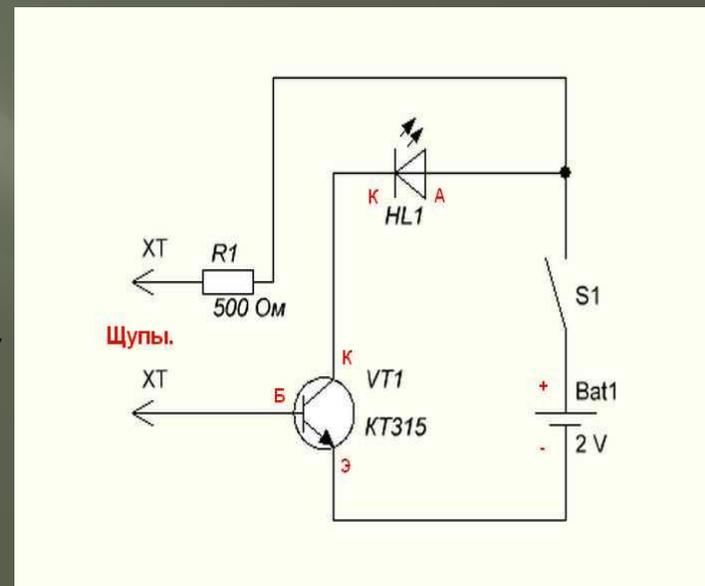
Второй вариант пробника, который совмещает в себе функции прозвонки позволяющей прозванивать цепи до 150 килоОм, и подходящий даже для проверки резисторов, катушек пускателей, обмоток трансформаторов, дросселей и тому подобного. И индикатора напряжения, как постоянного, так и переменного тока. При постоянном токе показывается напряжение уже от 5 вольт и до 48. Переменный ток показывает 220 и 380 вольт легко. Ниже приведена печатная плата этого пробника:
