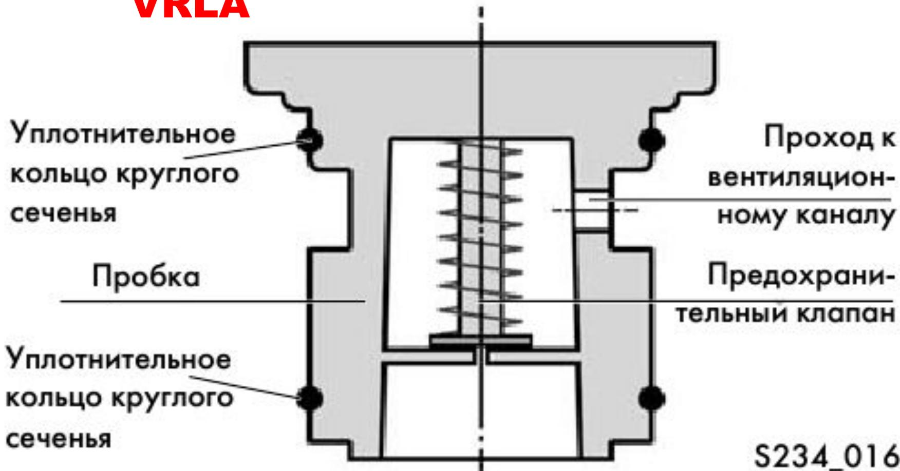
В пробки ячеек встроены предохранительные клапаны, которые пропускают газы в систему центральной вентиляции только при определенном избыточном давлении.
