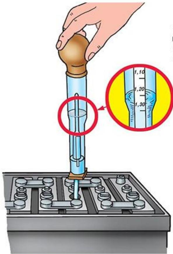
ДЛЯ ПРОВЕРКИ ПЛОТНОСТИ ЭЛЕКТРОЛИТА
