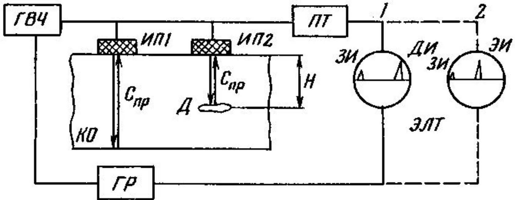
ГВЧ — генератор высокой частоты; ГР — генератор развертки;
