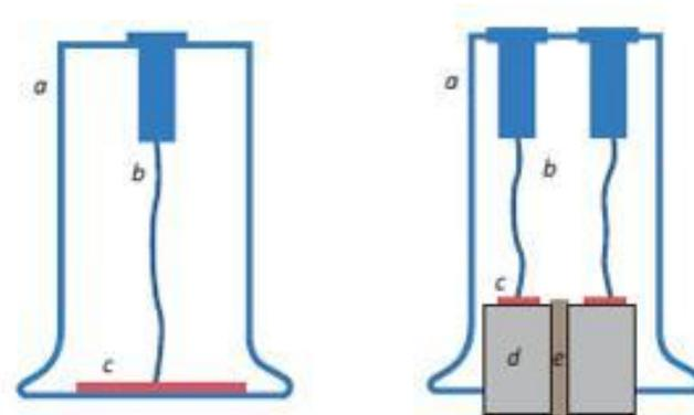
a – корпус ПЭП; b – проводник; c – пьезоэлемент; d – линия задержки; e – акустический экран
