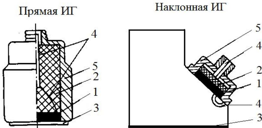
1 — пьезопластина; 2 — демпфирующий материал; 3 — протектор;
