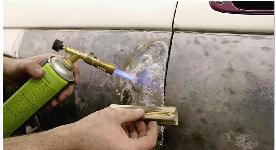
Единственное решение проблемы- срезать поврежденный участок и приварить заплатку. Или если сквозные отверстия небольших размеров, заплавить эти участки оловом. Только так можно обеспечить надежную и долговечную защиту.
