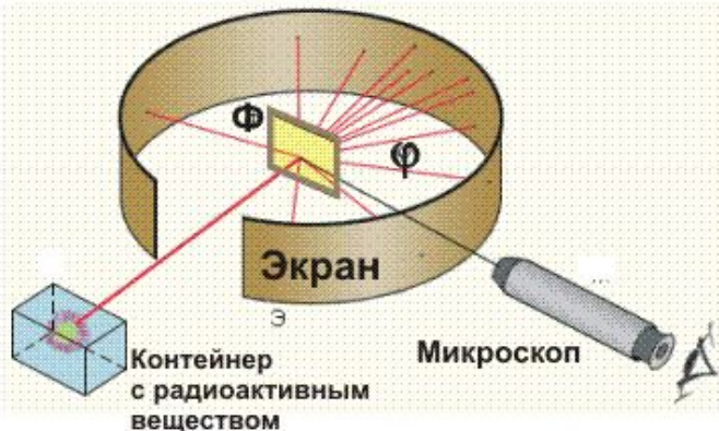
Схема опыта Резерфорда по рассеянию \alpha - частиц.
