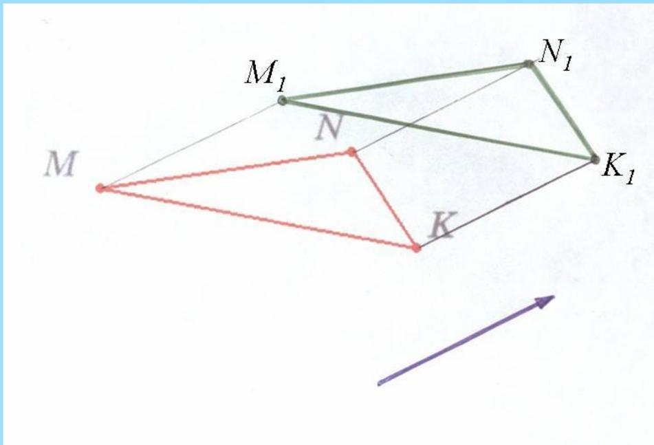
**Чтобы выполнить параллельный перенос треугольника  $MNK$  в заданном направлении на заданное расстояние, надо выполнить параллельный перенос каждой вершины этого треугольника в заданном направлении на заданное расстояние и соединить полученные точки отрезками.**
