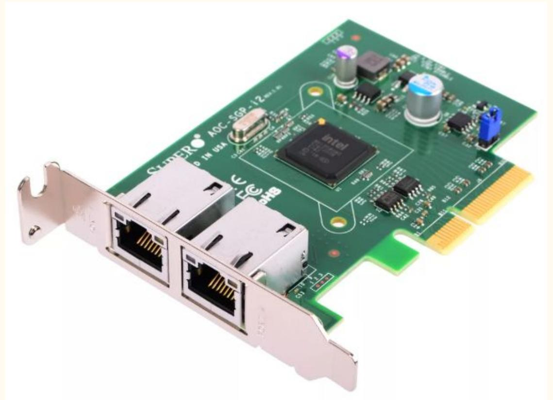
**Контроллер:** контроллер похож на мини-процессор, обрабатывает полученные данные. Будучи основной частью сетевого адаптера, контроллер напрямую определяет производительность сетевого адаптера.
