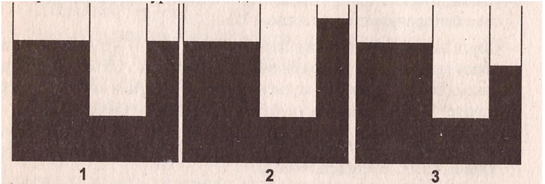
3) Два сосуда 1 и 2 заполнены одинаковой жидкостью. Кран **К** закрыт. Будет ли переливаться жидкость из одного сосуда в другой, если открыть кран?
