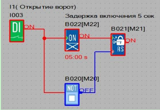
2. При добавлении к двум схемам на пре ведущем слайде блока функции «И» и «НЕ». Получаем схему с выдержкой 5 сек. до начала работы ворот и выдержкой 10 сек. на рабочий цикл ворот
