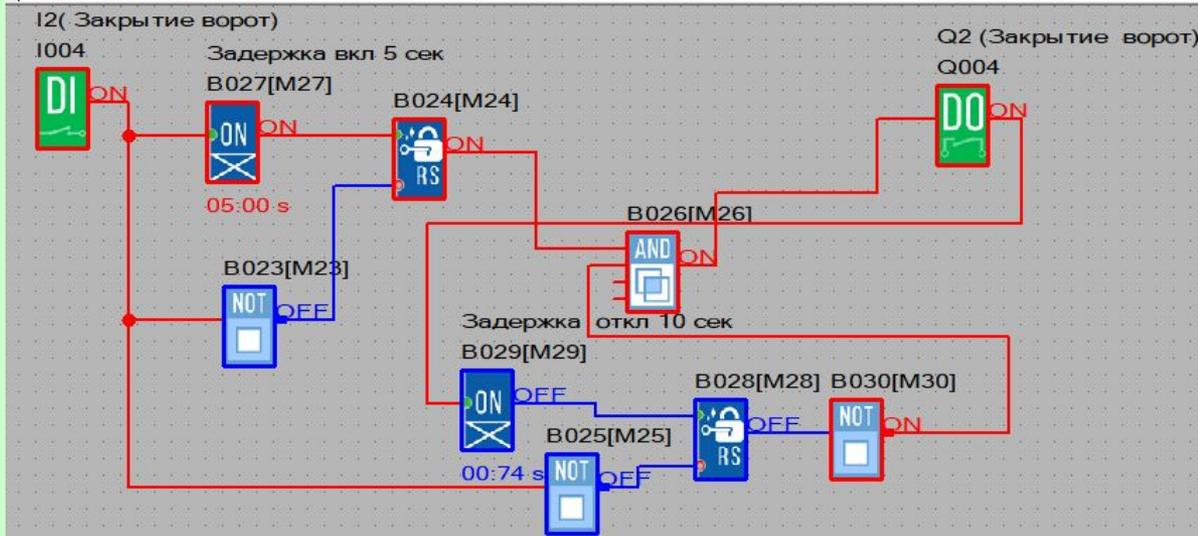
3. При добавлении к двум схемам на пре ведущем слайде двух блоков функции «НЕ». Получаем схему с функцией защиты от одновременного включения на открытие и закрытие ворот.
