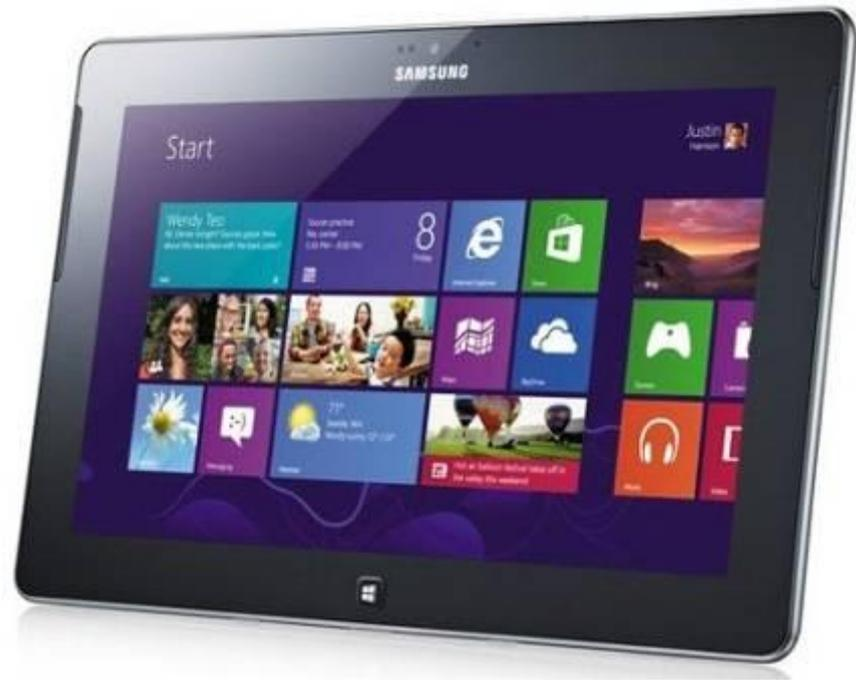
**Планшетный компьютер** (англ. *Tablet computer* или же электронный планшет) – персональная электронно-вычислительная машина без отдельного системного блока и без клавиатуры и мыши с ограниченными функциями. Планшетным компьютером можно управлять прикосновениями руки или стилуса (ручка со специальным силиконовым наконечником).
