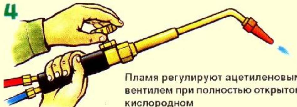
Пламя регулируют ацетиленовым вентилем при полностью открытом кислородном
