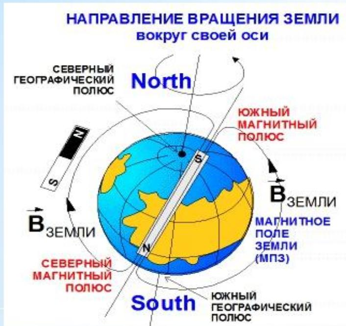
Северный конец магнитной стрелки указывает на северный полюс Земли (географический), а это значит, что **на севере Земли лежит южный магнитный полюс** Земли, его координаты  $75^{\circ},6$  с. ш.,  $101^{\circ}$  з. д. (данные на 1965 г.).
