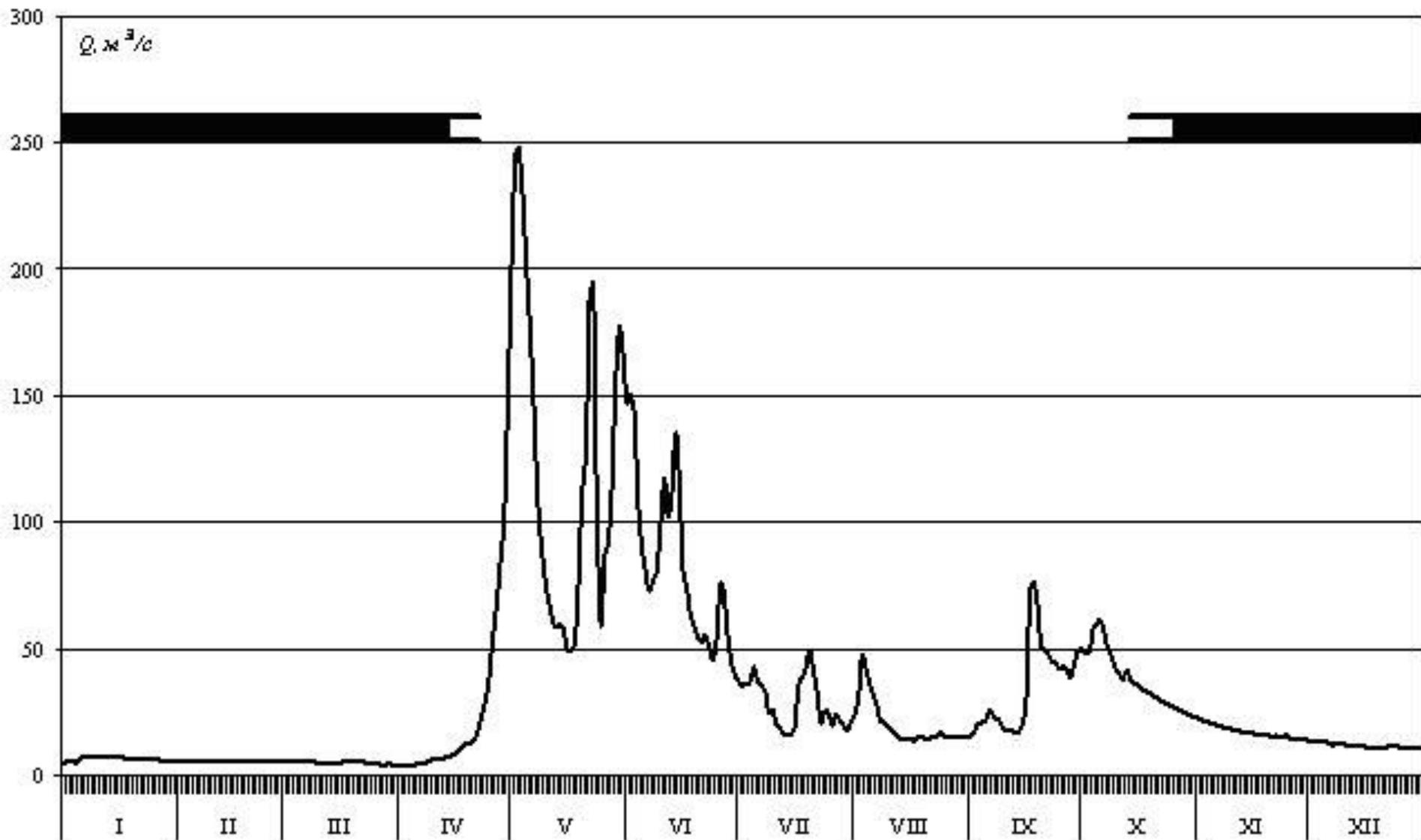
Гидрограф по посту р. Лобва – р.п. Лобва ( $F=2940 \text{ км}^2$ ) за средний по водности 1990 г.
