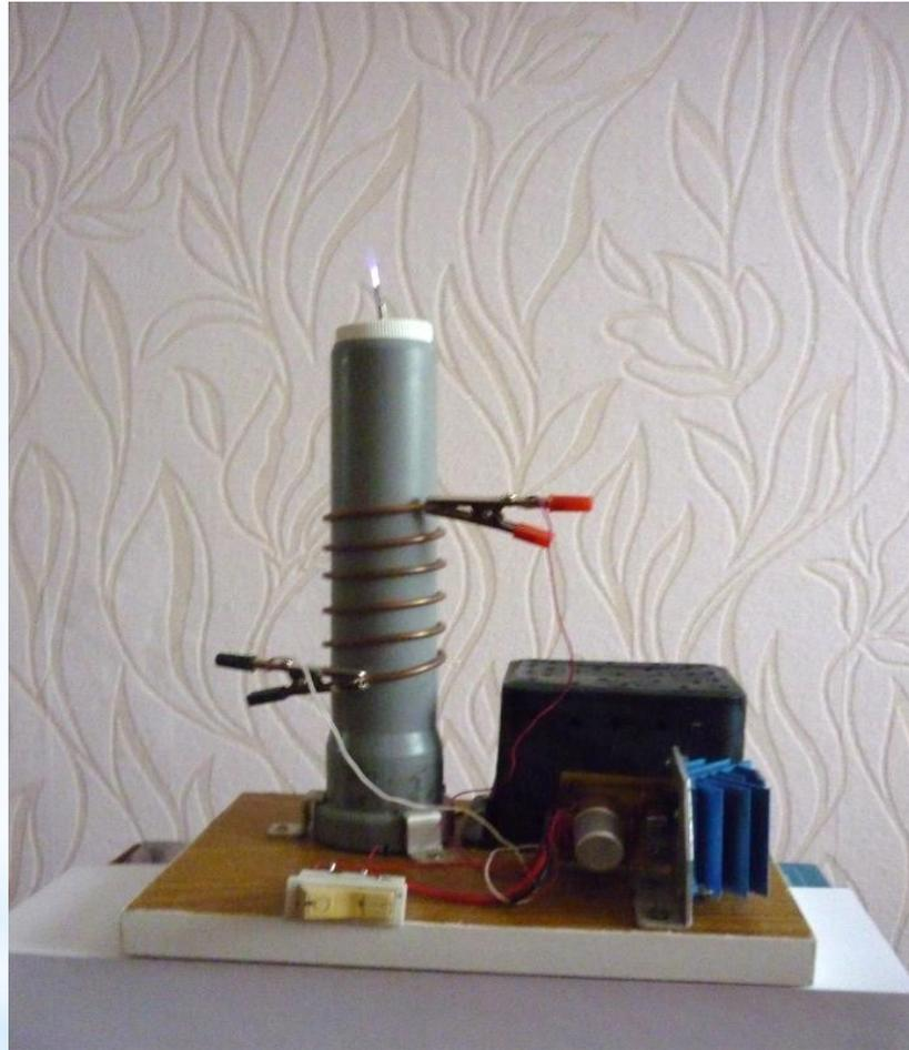
Путем перемещения обмотки первичной катушки вдоль оси и изменения шага намотки подбираем наибольший размер стиммера – светящегося разряда
