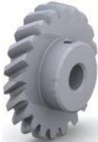
Косозубые шестерни – это модернизированная версия прямозубых шестерен. Зубья, в таком случае, расположены под углом к оси вращения. Зацепление зубьев этих шестерен происходит тише и плавно. Они применяются либо в малошумных механизмах, либо в тех которые требуют передачи большого крутящего момента на больших скоростях
