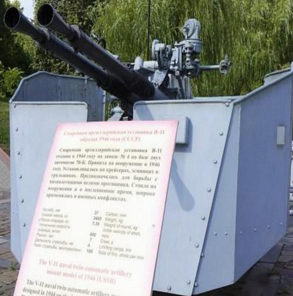
*Спаренная артиллерийская установка В-11 образца 1946 года (СССР)*
