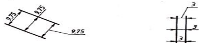
Рис. 44. Нанесение размерных чисел при недостатке места
