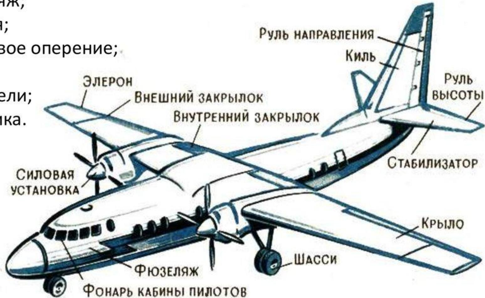
**Оперение** — совокупность аэродинамических поверхностей, обеспечивающих устойчивость, управляемость и балансировку самолёта в полёте. Оперение устанавливается в хвостовой или носовой части фюзеляжа. Состоит из **горизонтального** и **вертикального** оперения.
