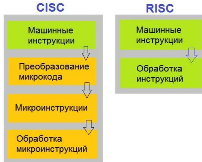
CISC – большие команды центральному процессору, которые разбиваются внутри на микроинструкции и в последствии выполняются разом
