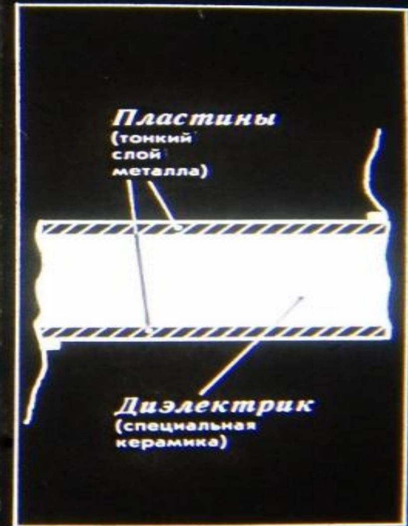
Большую емкость при малых размерах обеспечивает применение в конденсаторах керамического диэлектрика с высоким значением  $\epsilon$ .
