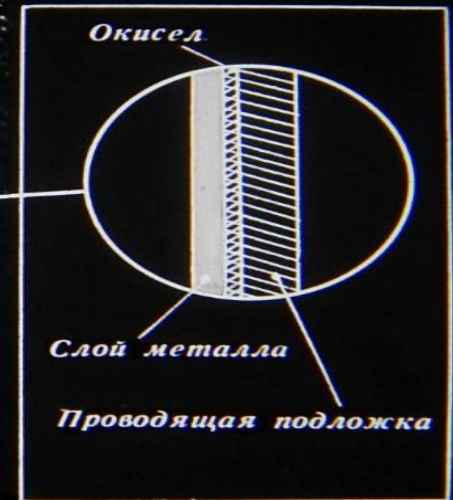
Для современных радиосхем, выполняемых в виде единого кристалла, разработаны сверхмалые конденсаторы. Такие конденсаторы могут иметь емкость до 1 мкФ на 1 см<sup>2</sup>.
