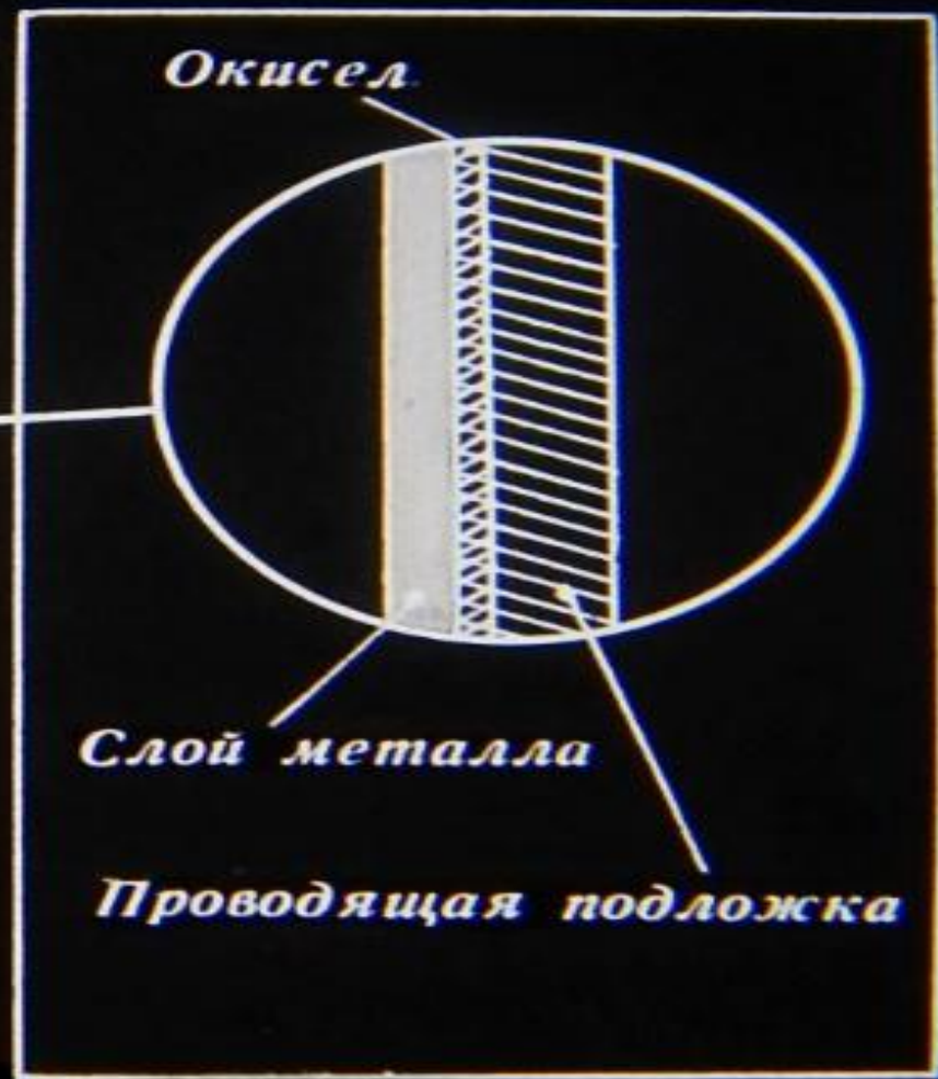
Для современных радиосхем, выполняемых в виде единого кристалла, разработаны сверхмалые конденсаторы. Такие конденсаторы могут иметь емкость до 1 \text{ мкФ} на 1 \text{ см}^2 .
