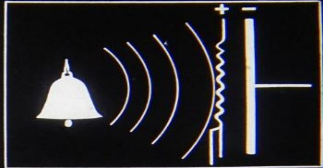
Если одну из пластин конденсатора сделать подвижной, то его емкость будет меняться при механических воздействиях. Это позволяет неэлектрические величины преобразовывать в электрические.
