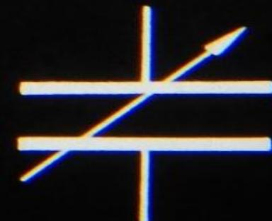
Изображения разных конденсаторов на принципиальных схемах.
