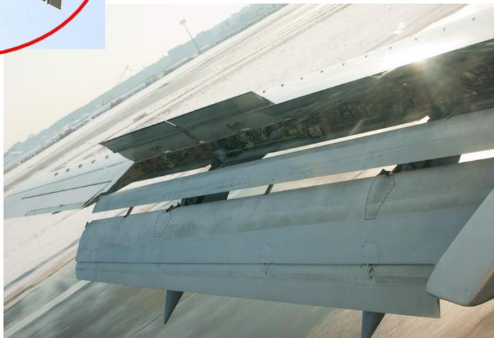
Для повышения несущей способности крыла (самолета) и снижения скорости на взлетно-посадочных режимах применяется взлетно-посадочная механизация крыла щитки, закрылки, предкрылки
