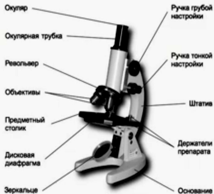
Внешний вид микроскопа Биомед 1
