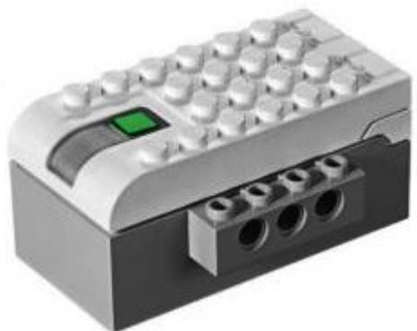
Смартхаб (Smarthub) – это интеллектуальный блок управления, к которому подключаются исполнительные устройства – двигатель и датчики, а сам смартхаб, в свою очередь, подключается к ноутбуку/компьютеру/планшету для получения управляющих команд. Одним словом, смартхаб – это «сердце» любого робота.
