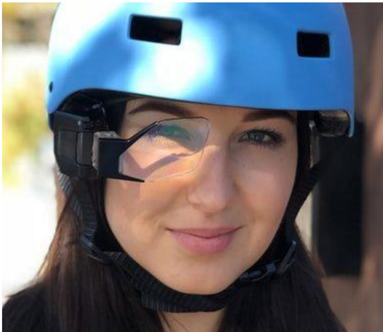
**Hudway Cast** - съемный дисплей, который можно установить на любой велосипедный или мотоциклетный шлем. Устройство состоит из нескольких частей. Это блок управления, универсальное крепление и сама линза с проектором.
