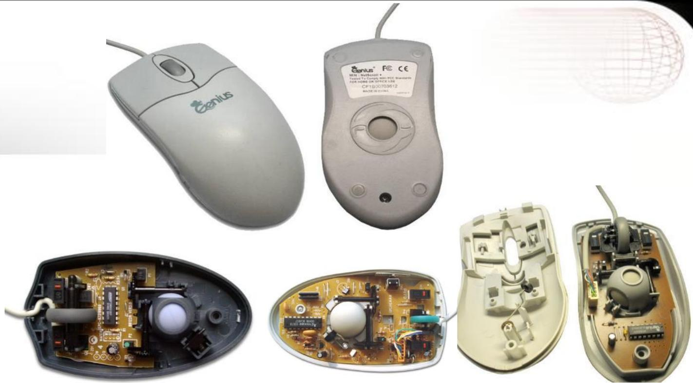
Шариковая мышь - один из первых способов «оживления» курсора на рабочем столе. Основа функционирования такой мыши - металлический обрезиненный шарик, который слегка выступает за пределы основания манипулятора. Первая мышь с шариком изобретена в далёком 1972 году.
