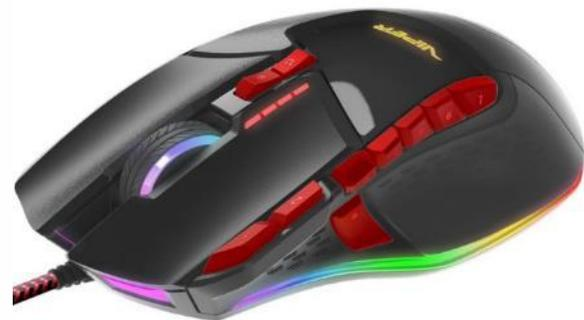
**Лазерная мышь - усовершенствованный вариант предыдущей технологии, где для подсветки используется полупроводниковый лазер.**
