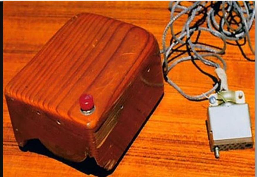
**В 1964 году Дуглас Энгельбарт под руководством компании NASA изготовил действующий прототип: деревянную коробку ручной работы, внутри которой находились два колеса и кнопка. Именно Энгельбарт назвал первенца МЫШЬЮ.**
