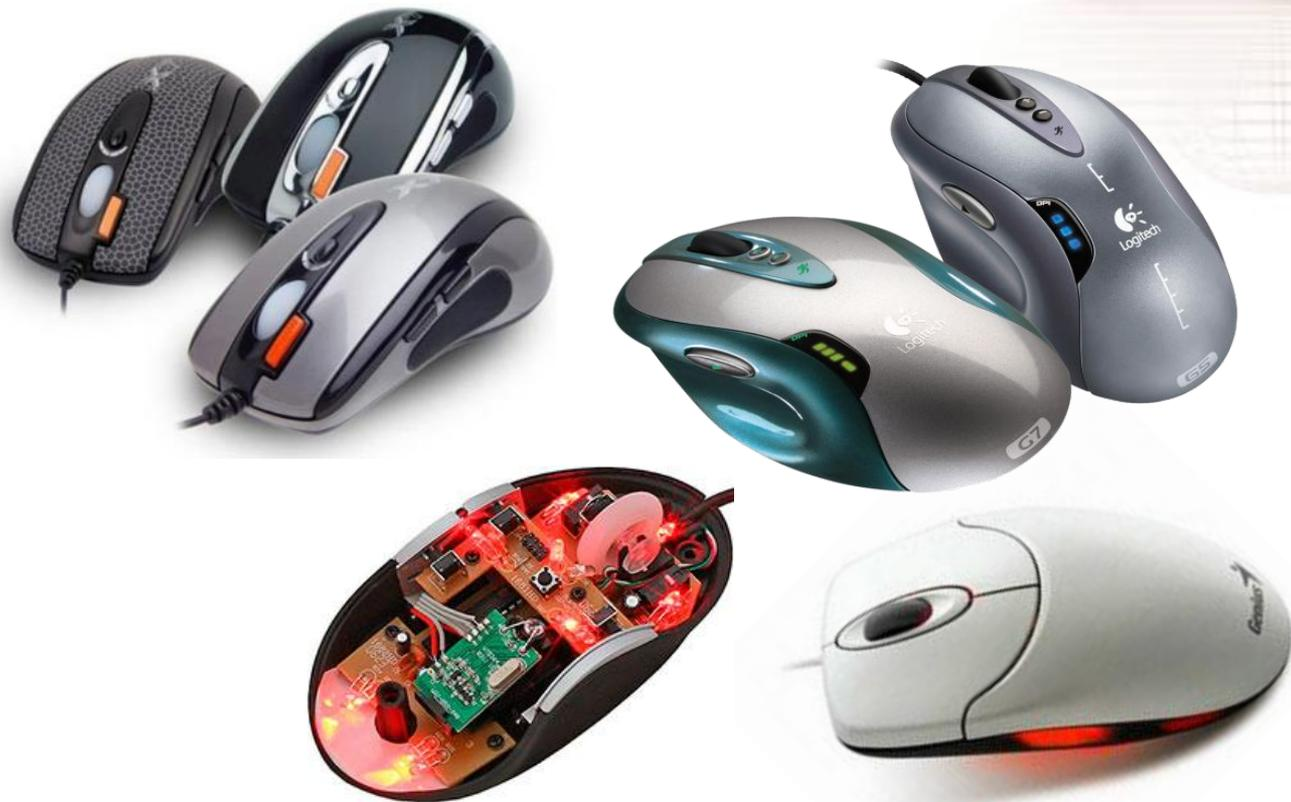
Оптическая мышь - сложное устройство, состоящее из нескольких элементов, взаимосвязанных и взаимодействующих между собой. Основой является миниатюрная камера, которая фотографирует рабочую поверхность, подсвеченную светодиодом, более тысячи раз в секунду.
