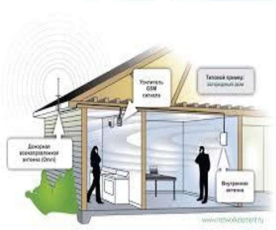
В целях повышения качества предоставления услуг связи ГКРЧ разрешено использование ретрансляторов подвижной радиотелефонной связи при выполнении следующих условий:
