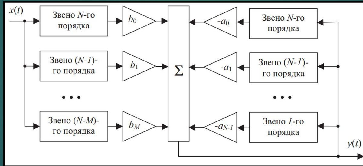
Основным элементом структурной схемы является звено  $n$ -го порядка с коэффициентом передачи  $H_n(s) = 1/s^n$ . Которое представляет собой последовательное соединение  $n$  интеграторов.
