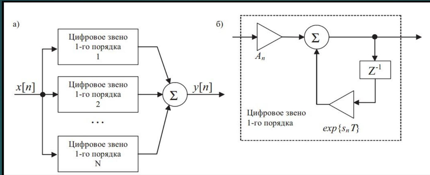
Учитывая, что умножение z-преобразование цифрового сигнала на  $z^{-1}$  эквивалентно задержке сигнала на период дискретизации  $T$ , получим схему реализации фильтра в виде  $N$  параллельно включенных цифровых звеньев первого порядка. Для доказательства устойчивости обратимся к формуле:
