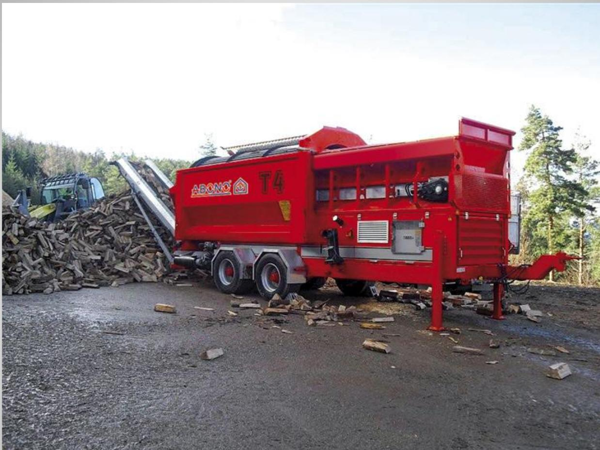
Передвижной барабанный просеиватель отходов ТБО
