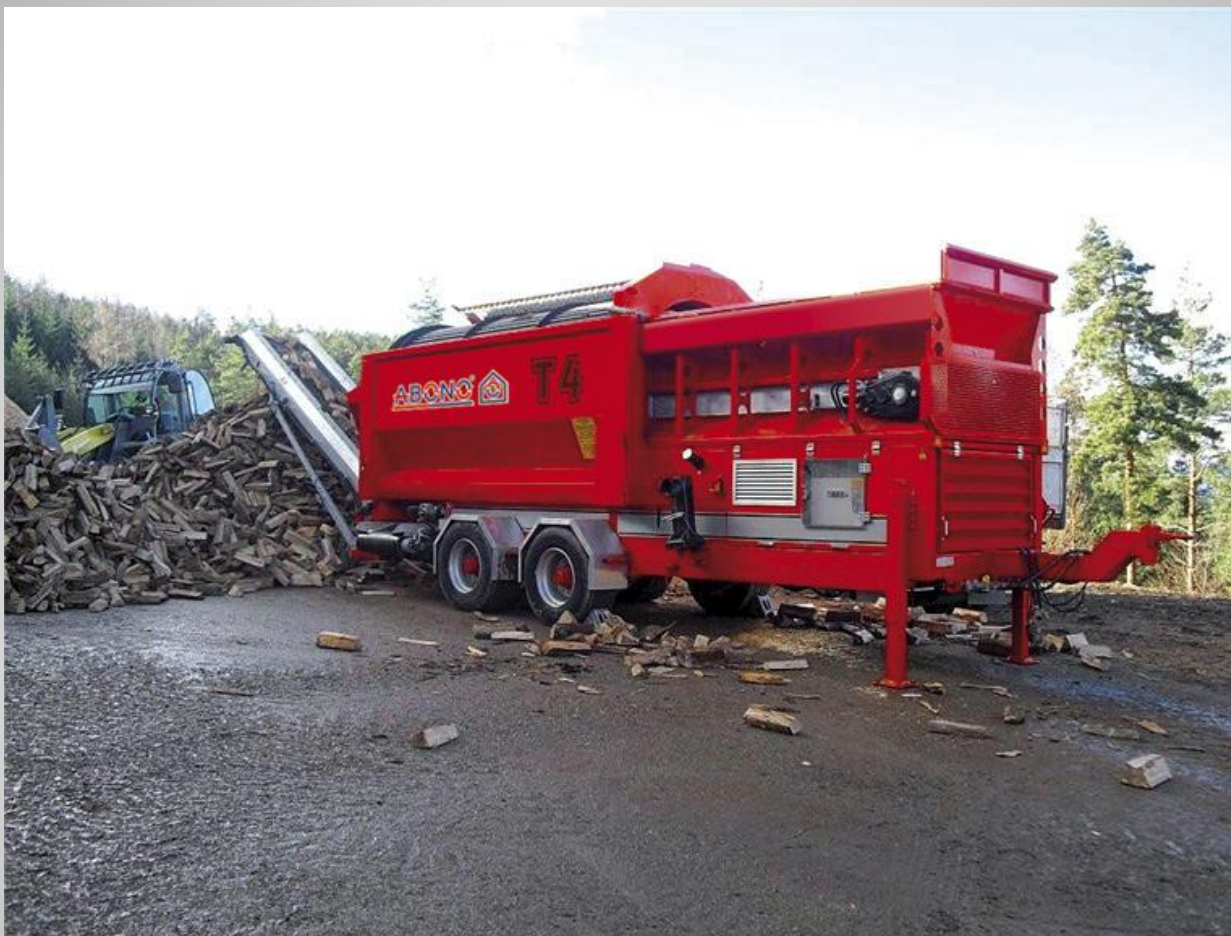
Передвижной барабанный просеиватель отходов ТБО (компактная профессиональная машина модели AVONO-T4 )
