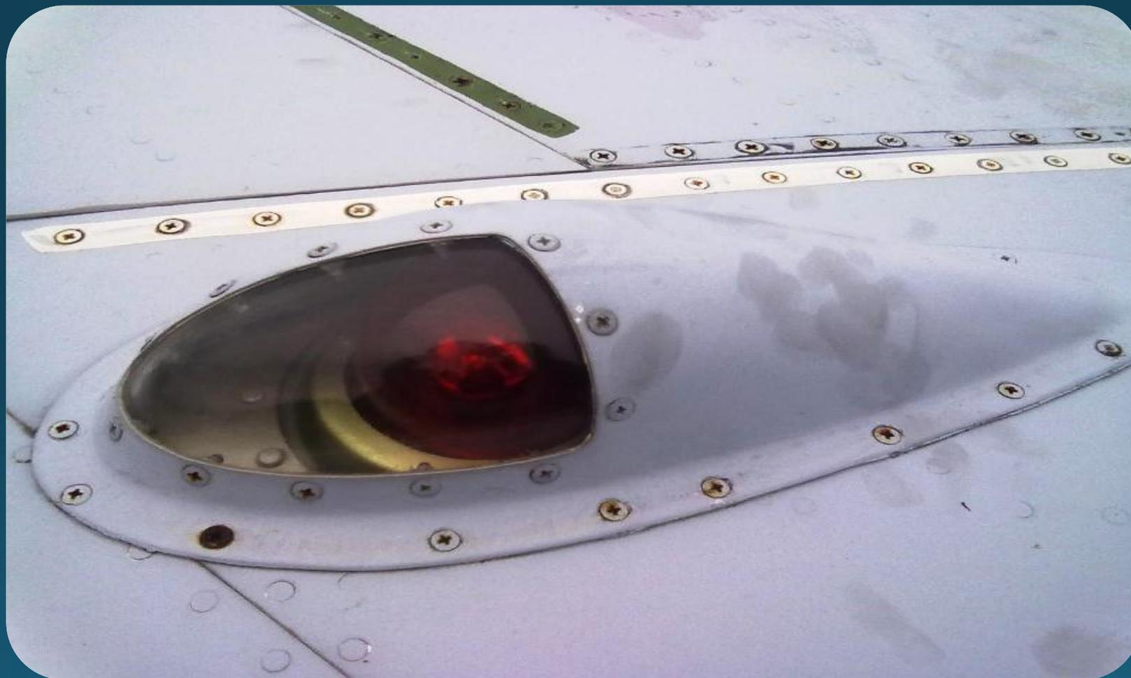
Для подсвета штанги топливоприёмника и конуса самолёта-заправщика при выполнении воздушной заправки в тёмное время суток на самолётах в носовой части могут устанавливаться фары подсвета штанги (ФПШ), конструктивно подобные фарам ПРФ, но меньшей мощности. Для обозначения контакта конуса и штанги оператору заправки в передней кромке киля (форкиле) заправляемого самолёта расположен сигнальный огонь «сцепка», белый или зелёный.
