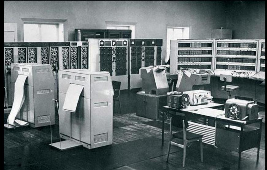
ЭВМ второго поколения. В СССР в 1967 году вступила в строй наиболее мощная в Европе ЭВМ второго поколения БЭСМ-6 (Большая Электронная Счетная Машина), которая могла выполнять 1 миллион операций в секунду.
