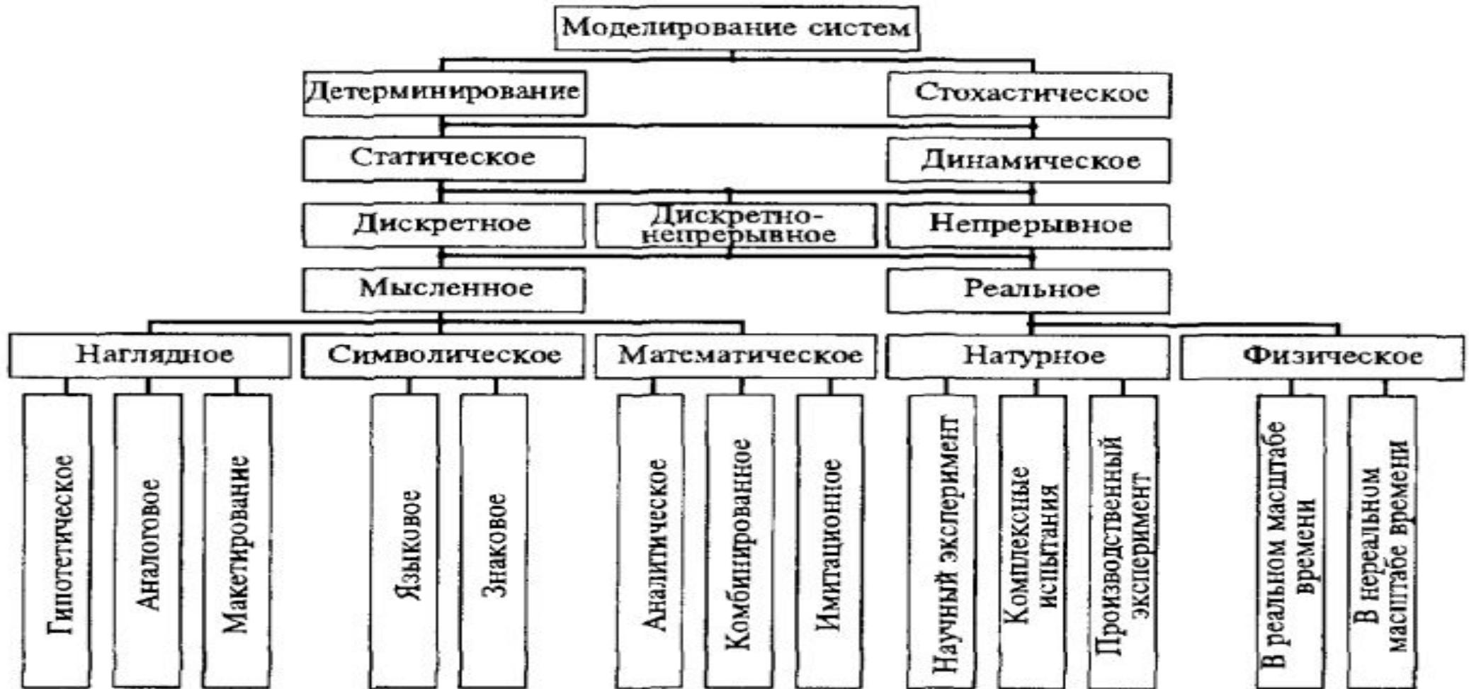
Рис. 1.2. Классификация видов моделирования систем
