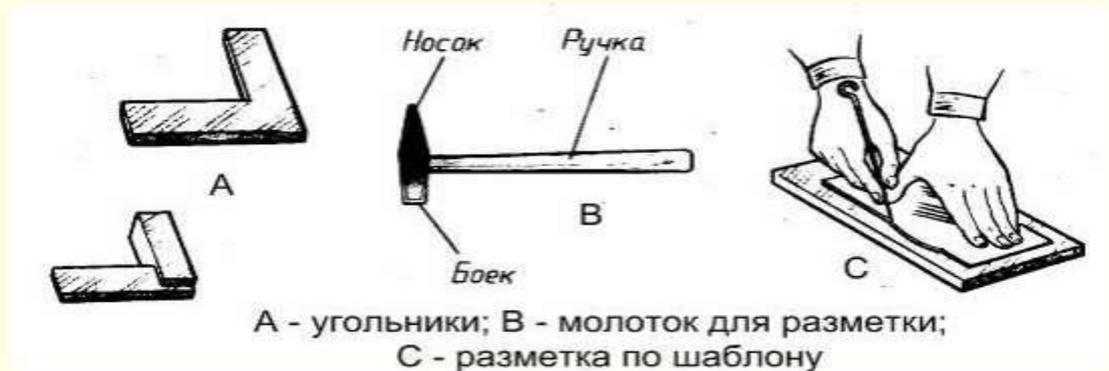
Перед разметкой требуется очистить заготовку от пыли и грязи. Размечать заготовку нужно так, чтобы как можно меньше металла уходило в отходы.
