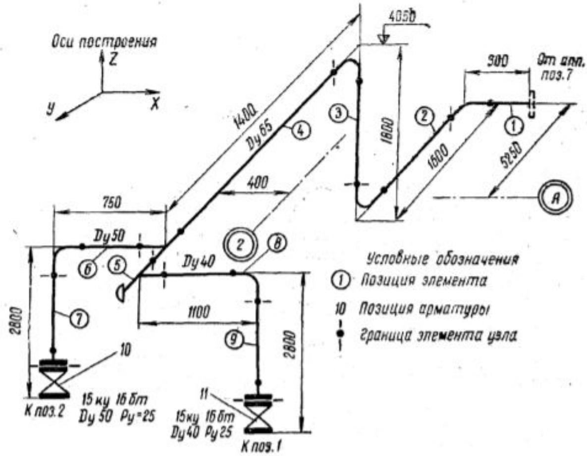
Детализированный чертеж технологических трубопроводов
