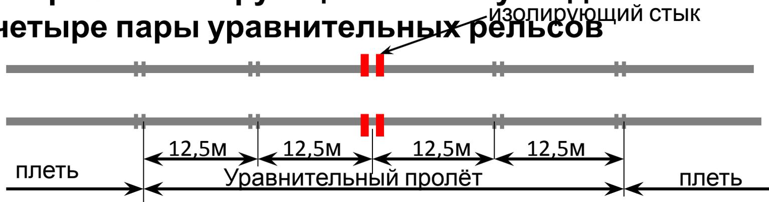
**При временном** закреплении плетей при температуре рельсов ниже или выше оптимальной в уравнительном пролёте укладывают
