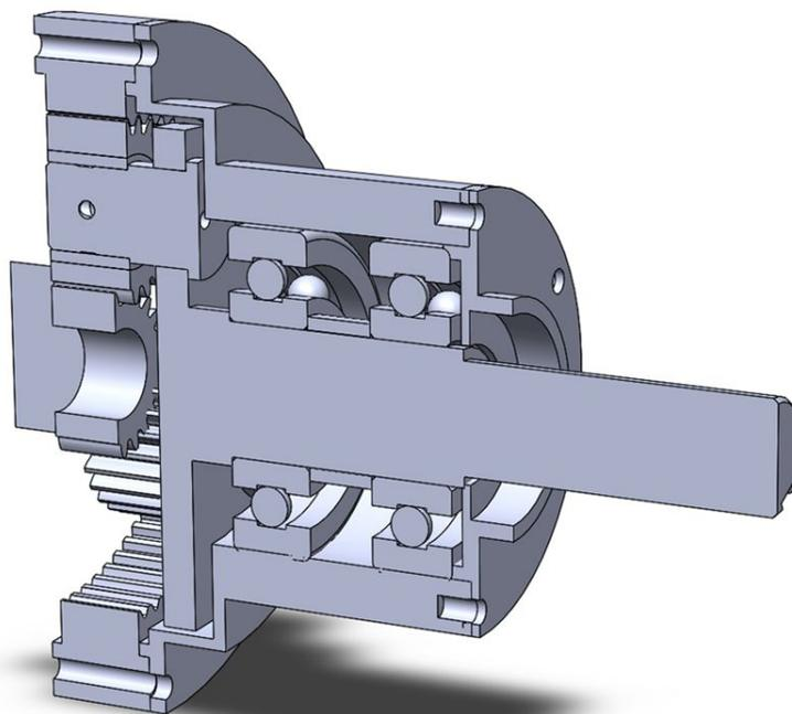
Твердотельное моделирование предусматривает последовательное выполнение булевых операций, таких как вычитания, сложения и пересечения над объемными примитивами (цилиндрами, конусами, призмами, пирамидами, сферами и т.д.). Объемные примитивы образуются путем выполнения перемещения плоской фигуры в пространстве. След от перемещения определяет форму примитива, например, смещение многоугольника образует призму, а поворот окружности вокруг оси — сферу.
