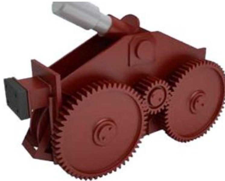
Приводные зубчатые колеса на валах ходовых колес
