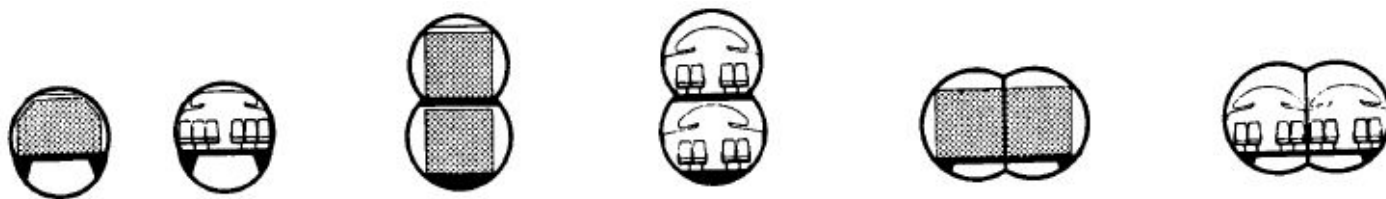
Рисунок 1.10 Различные формы поперечного сечения фюзеляжа
