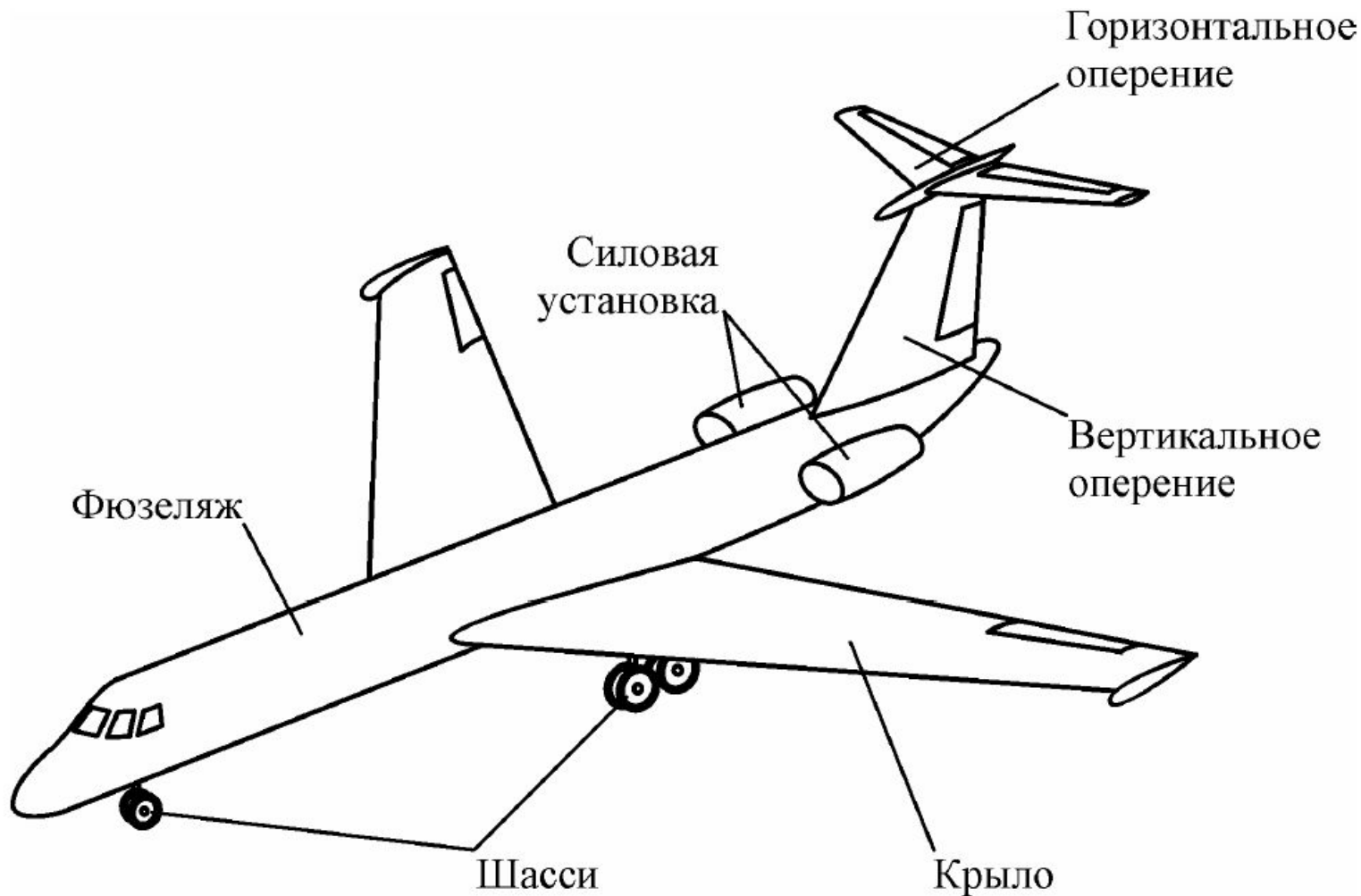
Рисунок 1.1 – Основные элементы самолёта
