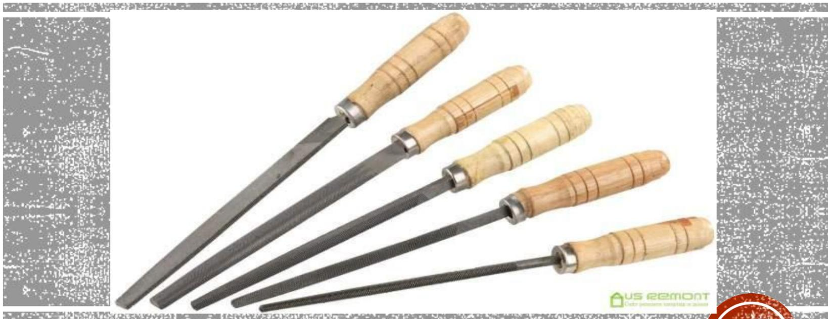
При **опиливании** **выбирают** **напильник** на **150** мм **длиннее** обрабатываемой заготовки.
