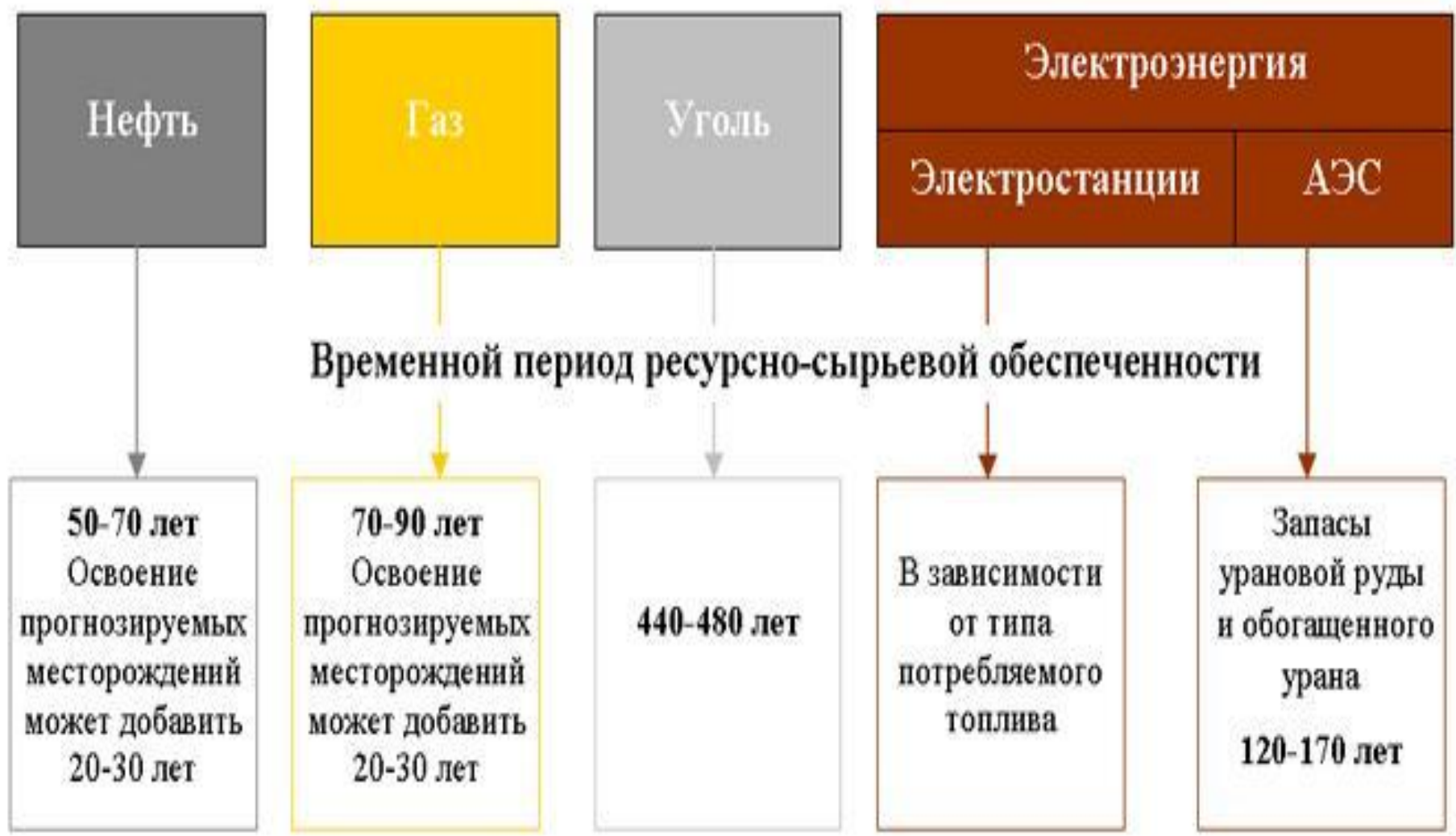
Рис. 1. Временная обеспеченность энергоресурсами
