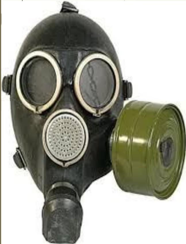
**Лицевая часть противогаза** обеспечивает подведение очищенного в противогазовой коробке воздуха к органам дыхания, удаление выдыхаемого воздуха, защищает глаза и лицо от попадания на них отравляющих веществ и бактериальных средств, а так же защищает лицо от ожогов световым излучением ядерного взрыва и зажигательным оружием.
