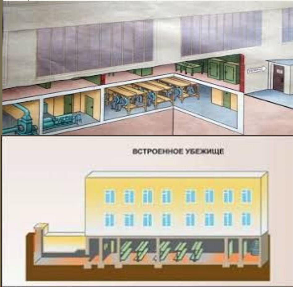
Противорадиационные укрытия обеспечивают защиту людей от ионизирующих излучений при радиационном заражении местности. Кроме того, они защищают от светового излучения, проникающей радиации (в том числе и от нейтронного потока) и частично от ударной волны, а также от попадания на кожу и одежду людей радиоактивных, отравляющих веществ и бактериальных (биологических) средств.
