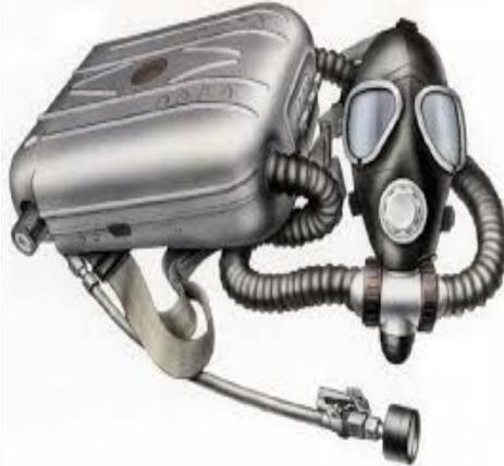
Принцип действия изолирующего противогаза основан на очистке выдыхаемого воздуха от углекислого газа, водяных паров и обогащения его кислородом в регенеративном патроне. К работе в изолирующем противогазе личный состав допускается после медицинского освидетельствования, прохождения курса обучения и тренировок в использовании изолирующим противогазом и
