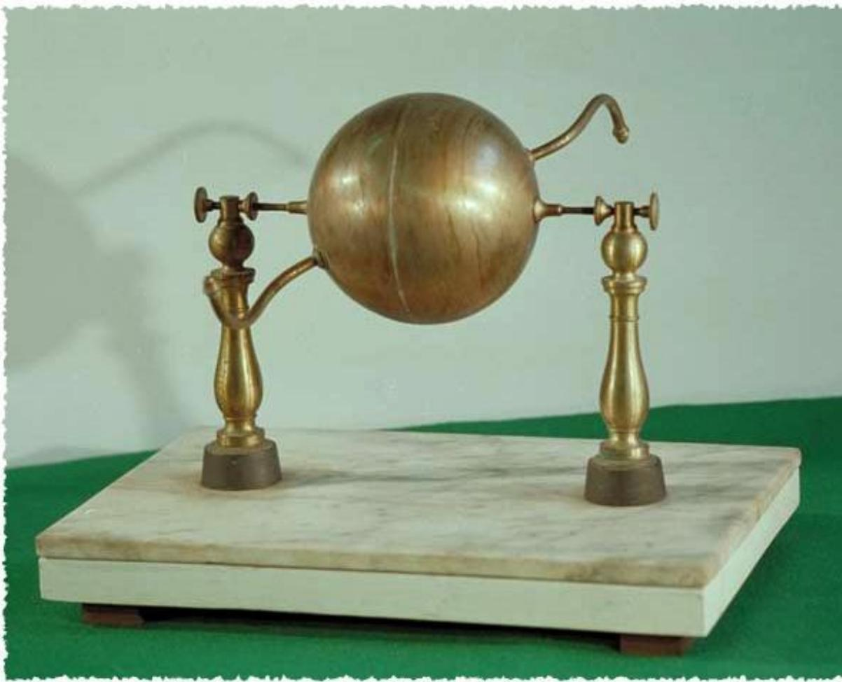
Герон Александрийский – греческий механик и математик. Одно из его изобретений носит название Шар Герона. В шар наливалась вода, которая нагревалась огнем. Вырывающийся из трубки пар враштал этот шар. Эта установка иллюстрирует реактивное движение.
