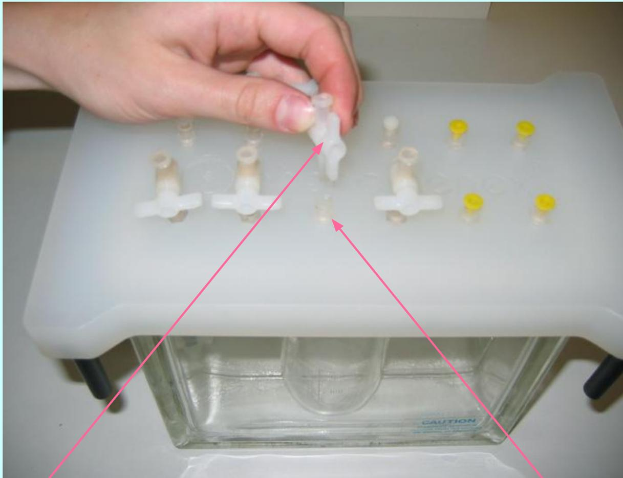
8. Запорные краны вставляются во внешние фитинги, которые будут задействованы в процессе твердофазной экстракции либо будут использоваться для регулировки давления в системе.
