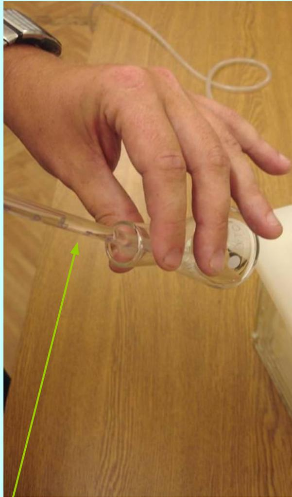
5. С помощью пипетки отбирается нужное количество элюирующей жидкости.
