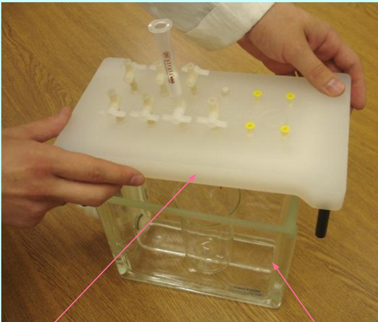
7. Крышка устройства снимается с камеры.
