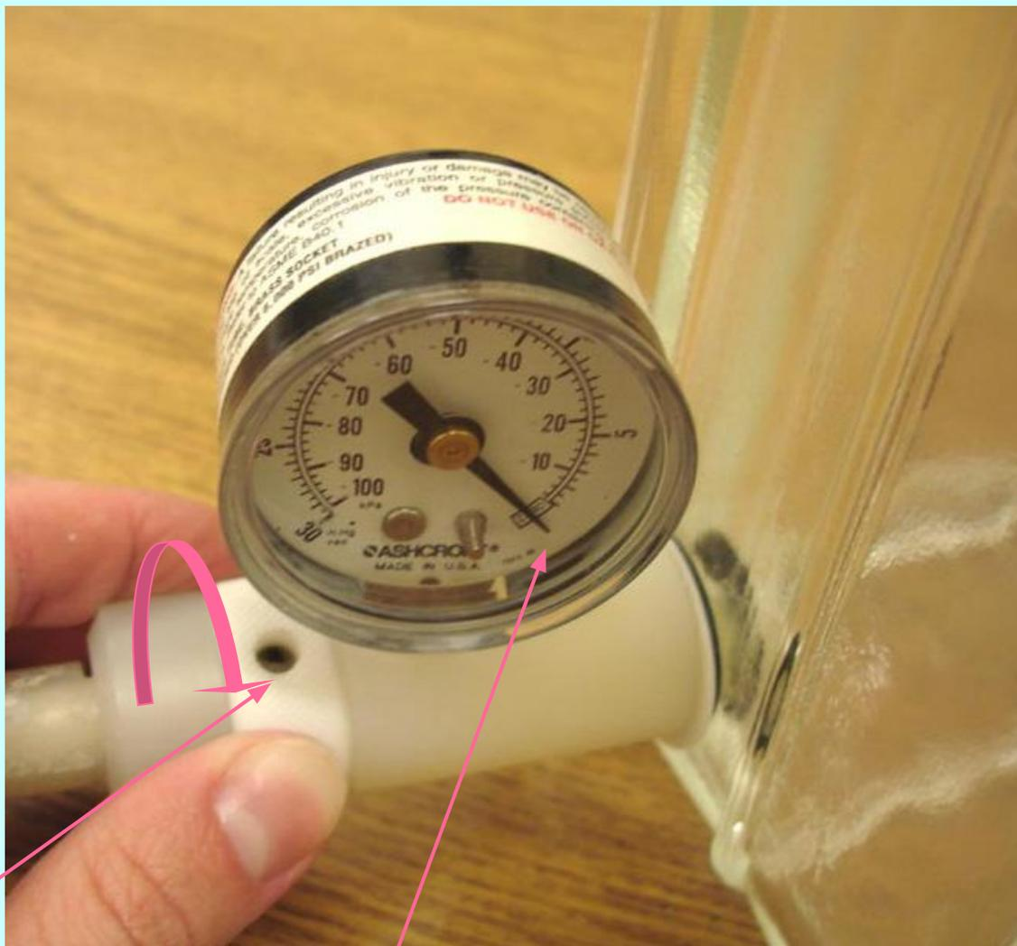
6. Вакуум в системе сбрасывают, максимально открывая отверстие вакуумной линии при помощи регулировочного вентилля.
