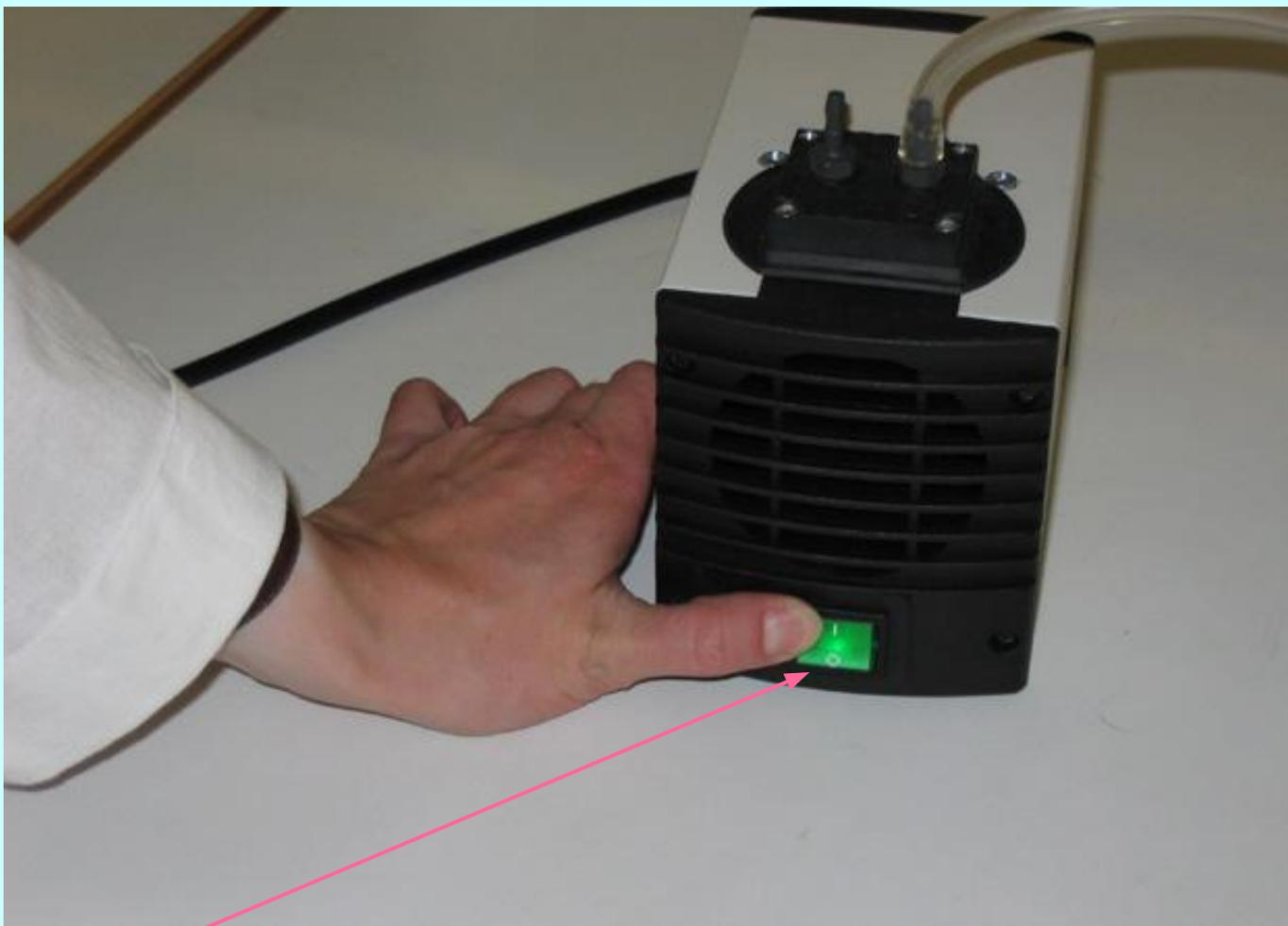
6. Включается вакуумный насос. Запорные краны при этом должны быть закрыты.
