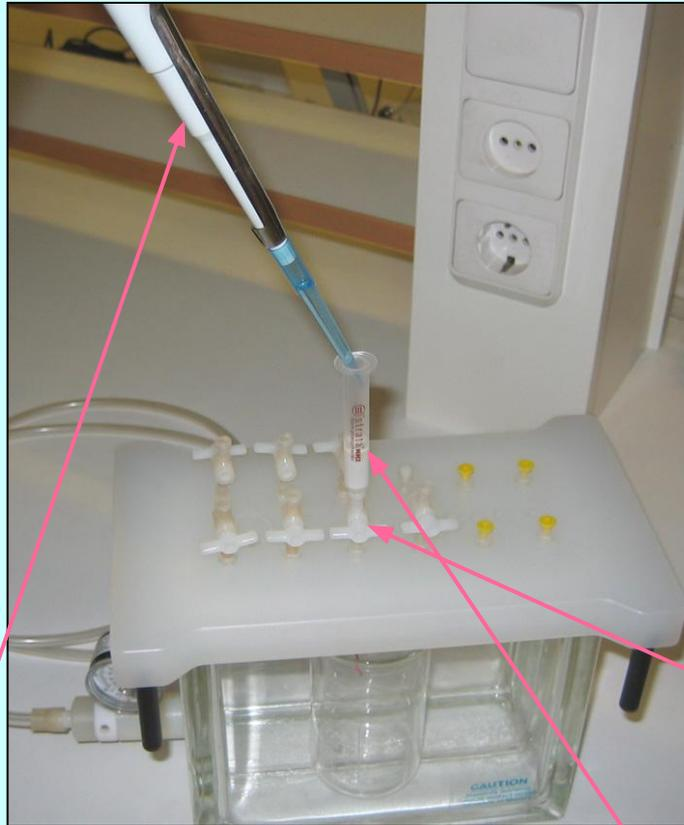
1. С помощью пипет-дозатора или пипетки на патрон наносится жидкость для его кондиционирования/уравновешивания. Запорный кран под патроном должен быть **закр<sup>ы</sup>т** (ручка установлена перпендикулярно оси протекания жидкости).
