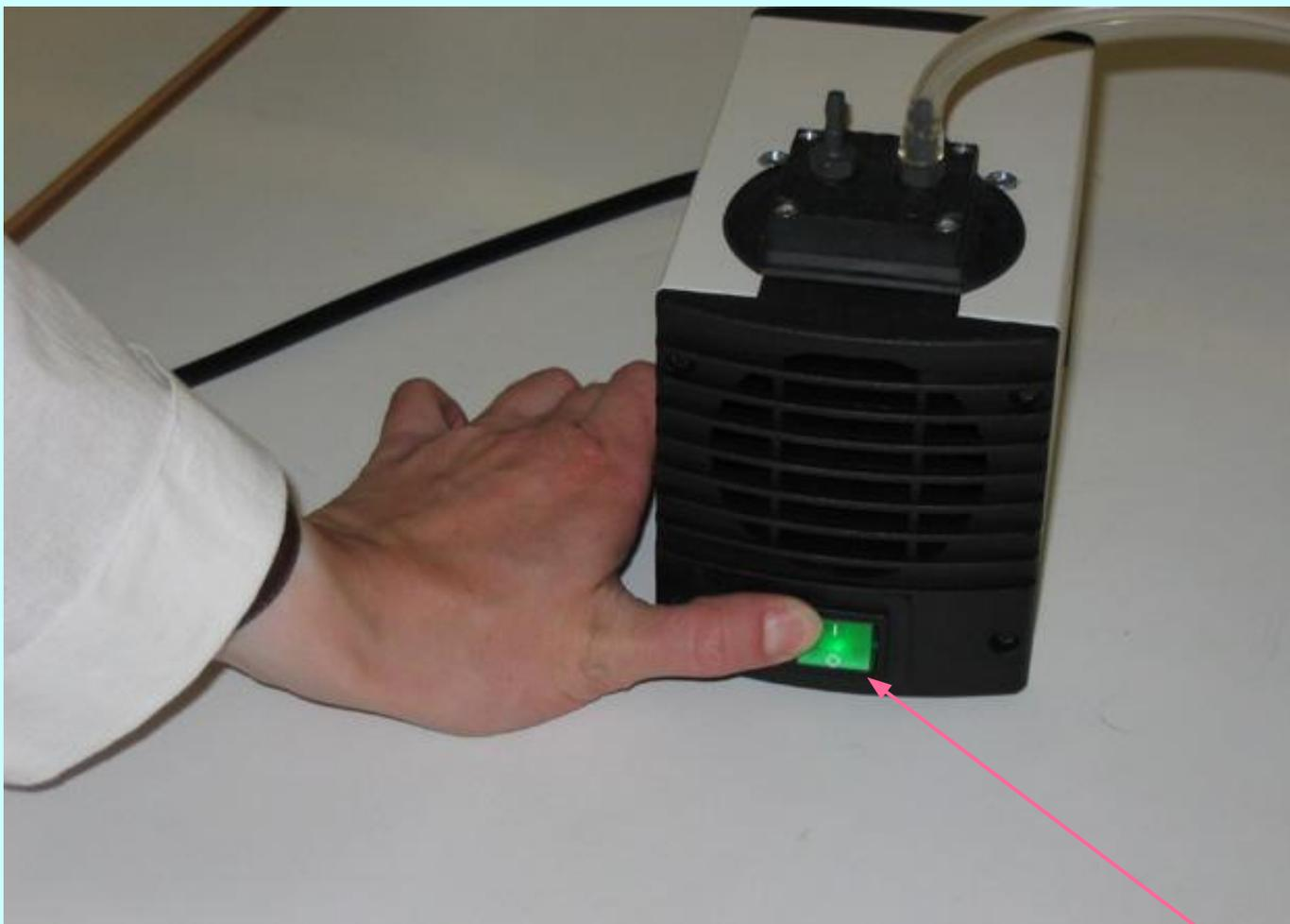
5. По окончании процесса элюирования вакуумный насос выключается.
