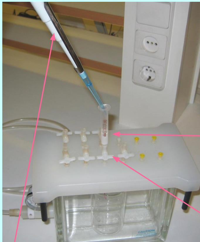
1. С помощью пипет-дозатора или пипетки на патрон наносится жидкость для кондиционирования/уравновешивания. Запорный кран под патроном должен быть **закрыт** (ручка установлена перпендикулярно оси протекания жидкости).
