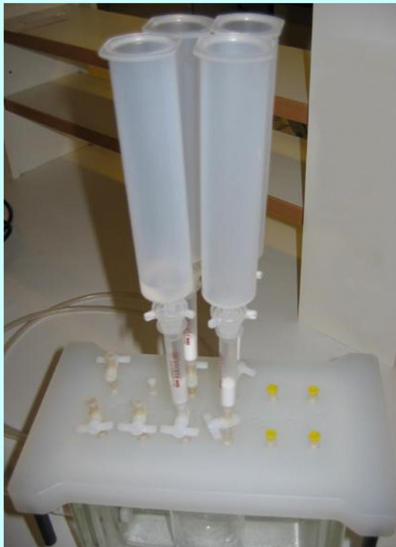
Вид установки сверху в случае одновременного использования четырех позиций для ТФЭ.
