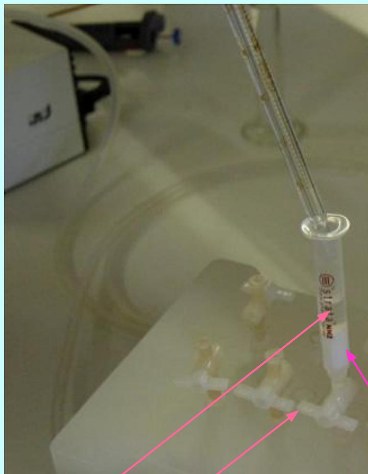
6. Производится загрузка элюирующей жидкости на патрон. При этом запорный кран должен быть закрыт.
