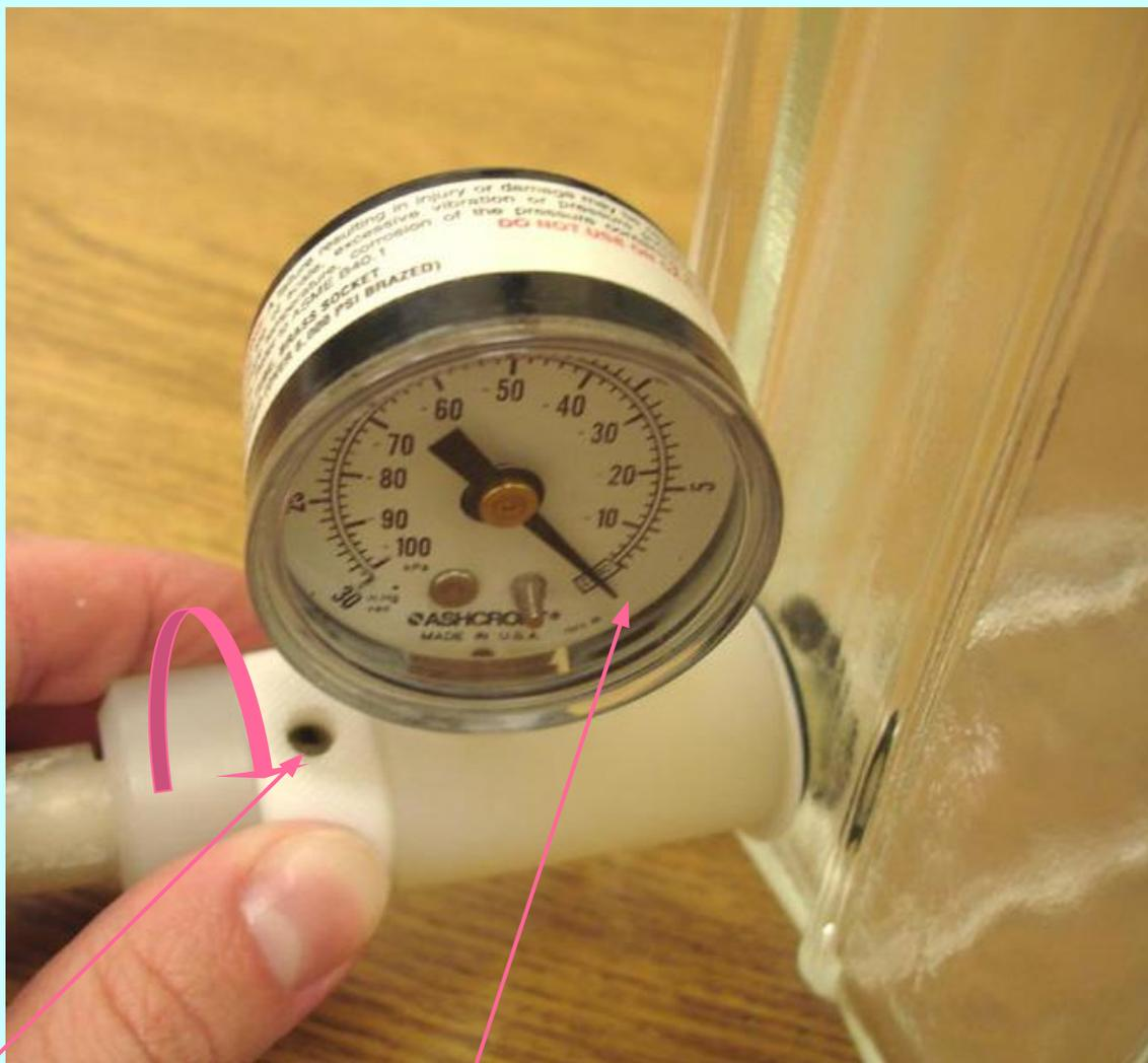
6. Вакуум в системе сбрасывают, максимально открывая отверстие вакуумной линии при помощи регулировочного вентиля.
