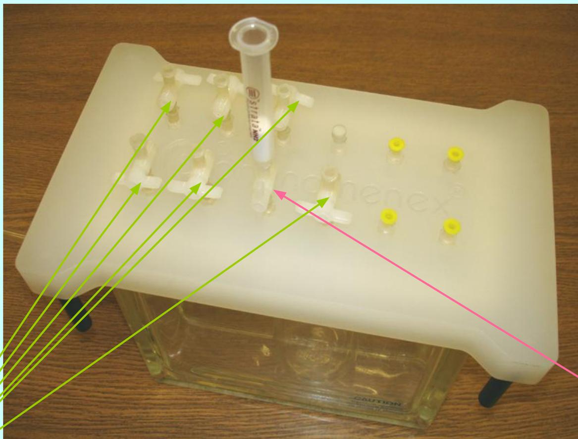
Все запорные краны, кроме крана, соединенного с высушиваемым патроном, закр<sup>ы</sup>ты.
