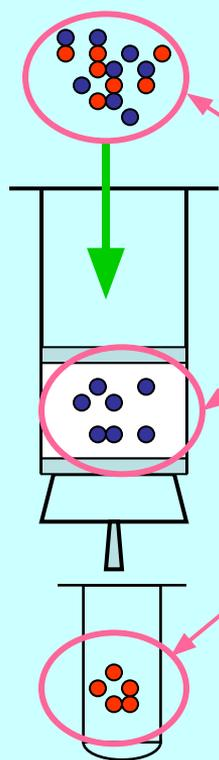
При неудерживающей твердофазной экстракции целевой компонент с примесями наносится на подготовленную ТФЭ-колонку. После этого, в процессе элюирования на сорбенте удерживается часть примесей, а целевой анализируемый компонент отправляется в емкость для сбора экстракта.
