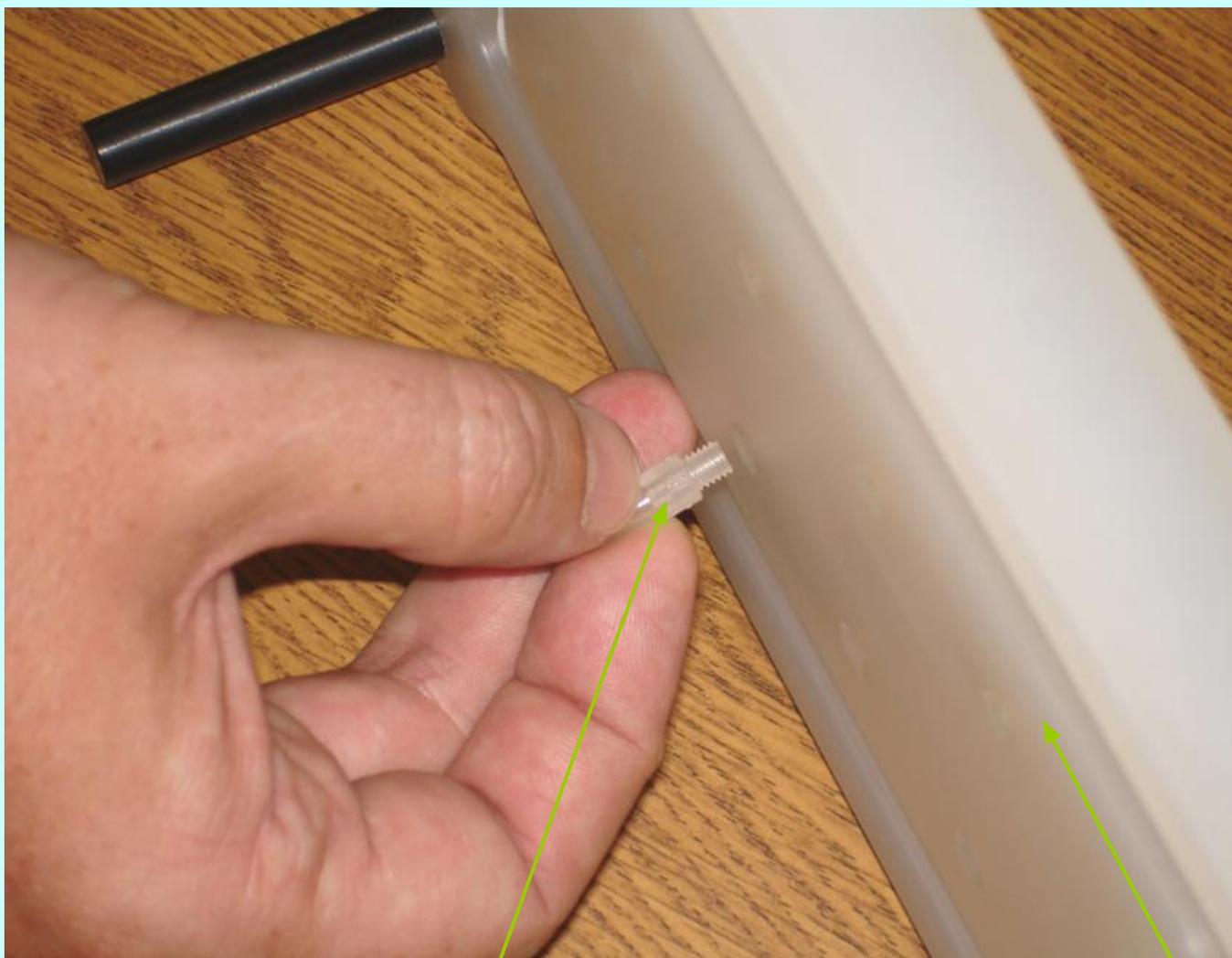
2. Внутренний фитинг присоединяется (заворачивается по резьбе) к внутренней поверхности крышки устройства.
