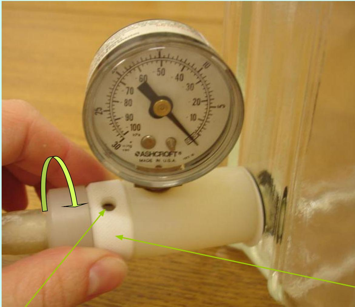
а также регулированием давления в системе (путем изменения размера отверстия в вакуумной линии регулирующим вентилем или с помощью незадействованных для твердофазной экстракции запорных кранов).
