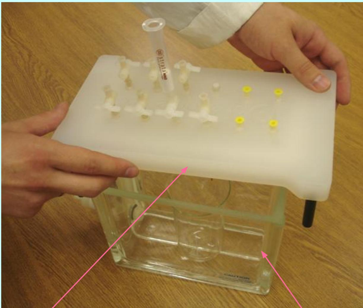
7. Крышка устройства снимается с камеры.
