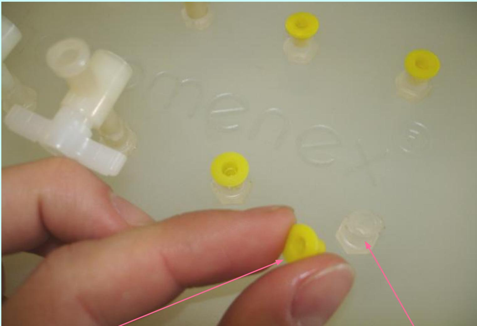
7. Заглушки присоединяются к внешним фитингам, которые не будут задействованы в процессе твердофазной экстракции или использованы для регулировки давления в системе.
