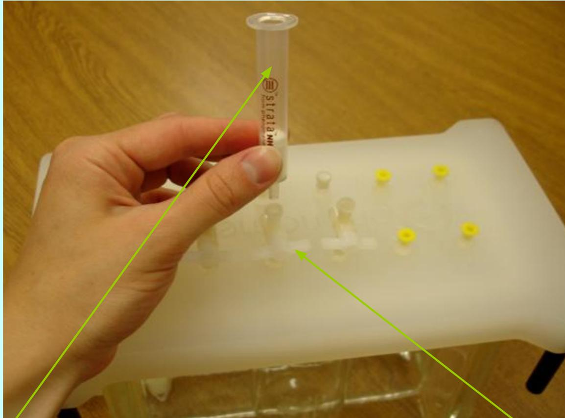
9. Патрон (картридж) присоединяется к запорному крану, который будет задействован в процессе твердофазной экстракции.
