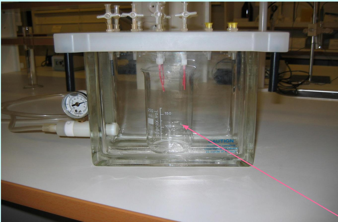
5. В резервуар наливается оставшийся объем пробы. Проводят элюирование аналогично описанному выше. Режим элюирования подробно описан в методиках выполнения измерений и методических указаниях.
