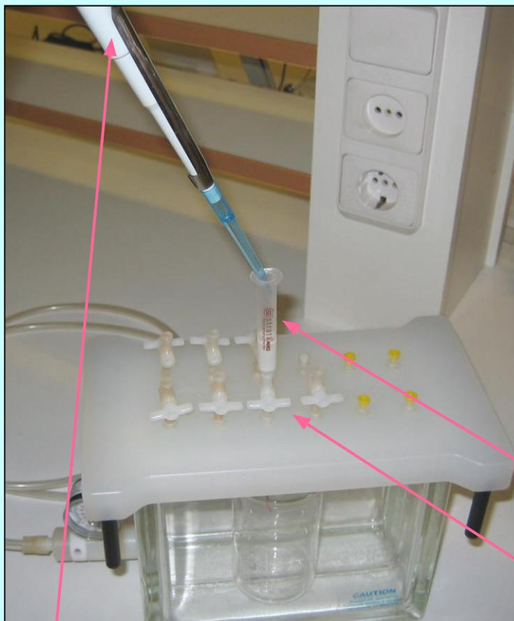
2. С помощью пипет-дозатора или пипетки на патрон наносится количество пробы, составляющее около  $3/4$  вместимости патрона. Запорный кран под патроном должен быть **закрыт**.
