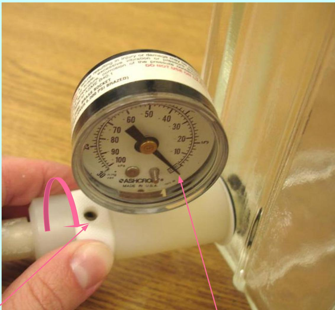
10. Вакуум в системе сбрасывают, максимально открывая отверстие вакуумной линии при помощи регулировочного вентиля.
