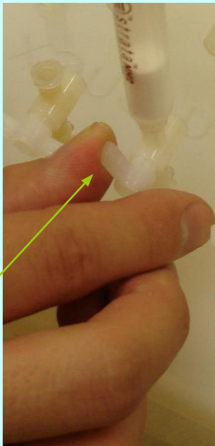
3. Запорный кран поворачивается в положение, позволяющее поддерживать нужную скорость элюирования. Управление скоростью потока жидкости, проходящего через патрон, осуществляется с помощью запорного крана,
