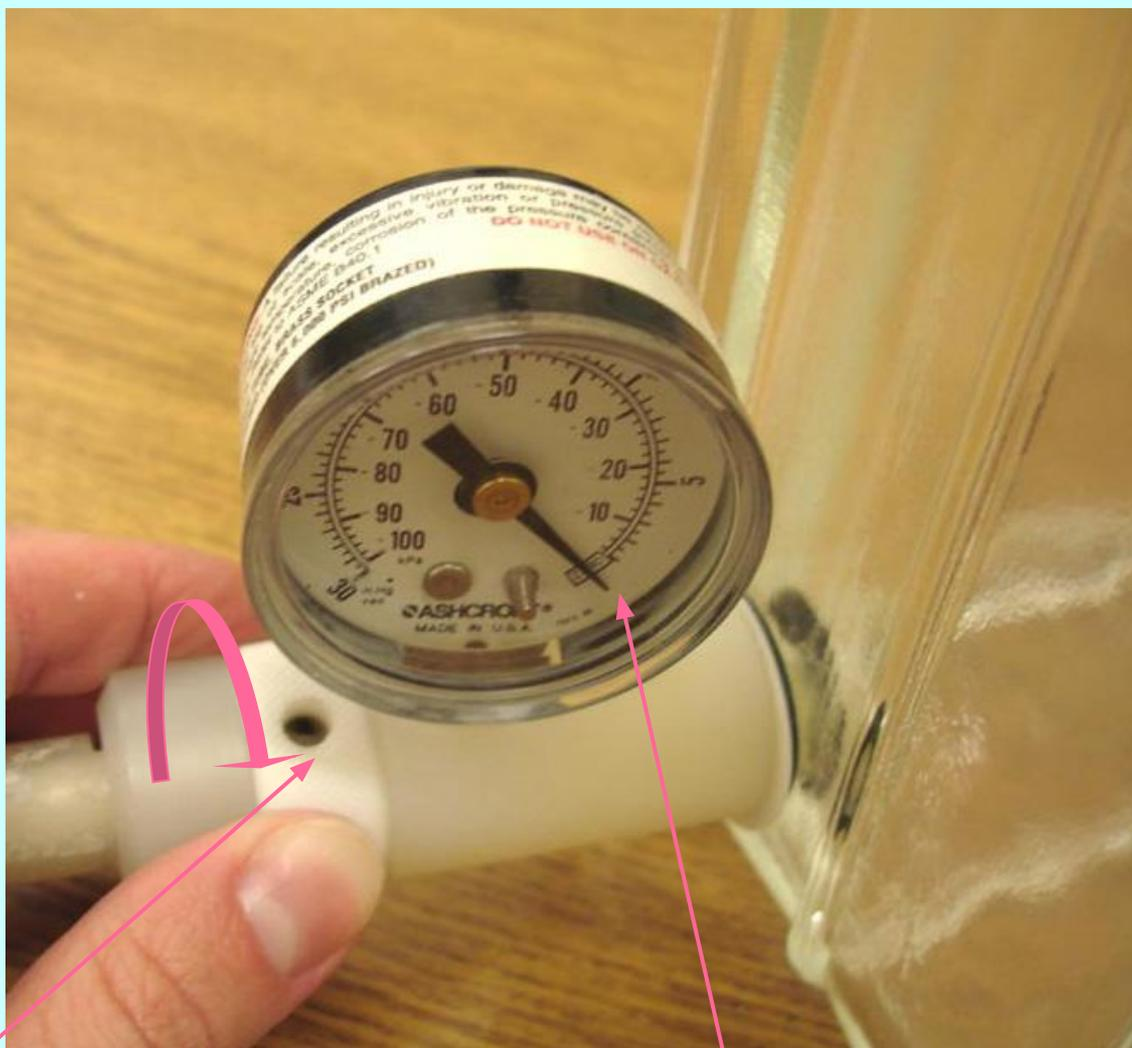
3. Вакуум в системе сбрасывают, максимально открывая отверстие вакуумной линии при помощи регулировочного вентиля.
