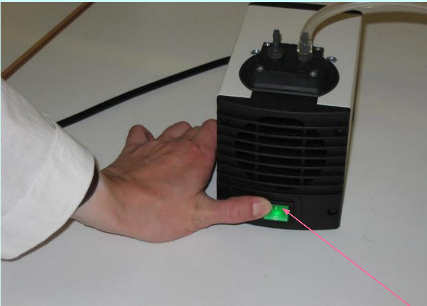
9. По окончании процесса элюирования вакуумный насос выключается.
