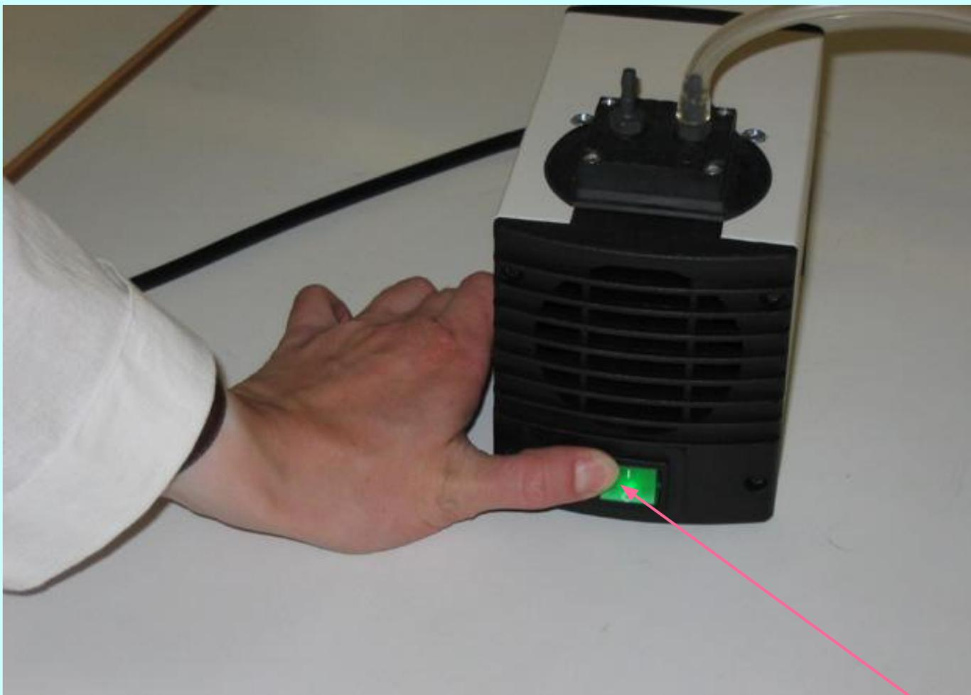
10. По окончании процесса элюирования вакуумный насос выключается.
