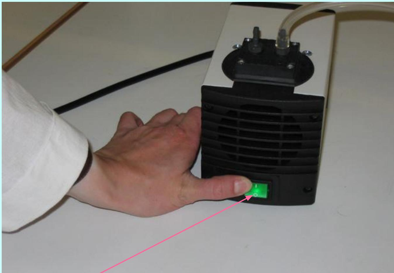
7. Включается вакуумный насос. Запорные краны при этом должны быть закрыты.
