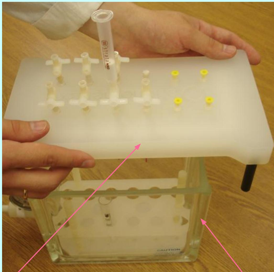
12. Крышка устройства снимается с камеры.
