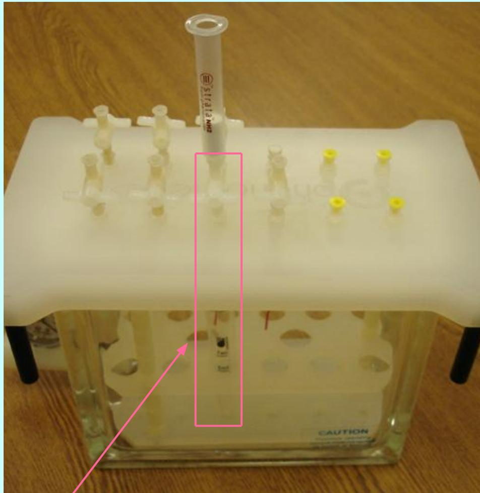
9. Процесс элюирования продолжается до полного выхода элюата.
