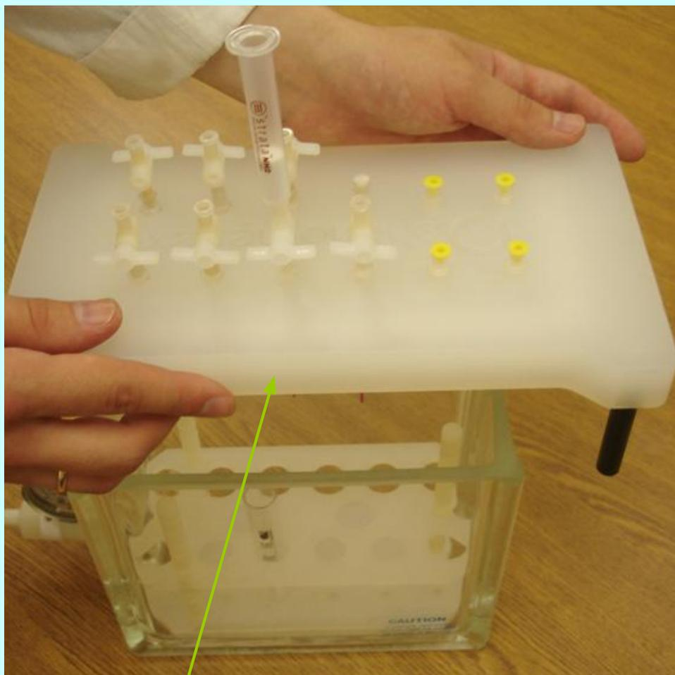
4. Камера закрывается крышкой устройства. Необходимо следить, чтобы игла была опущена в пробирку.
