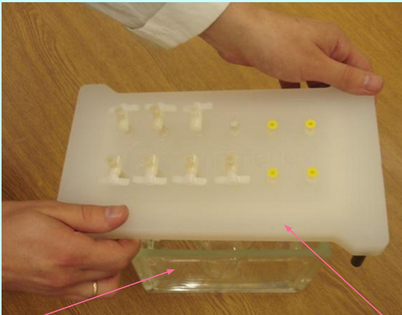
6. Камера со стаканом закрывается подготовленной крышкой устройства.
