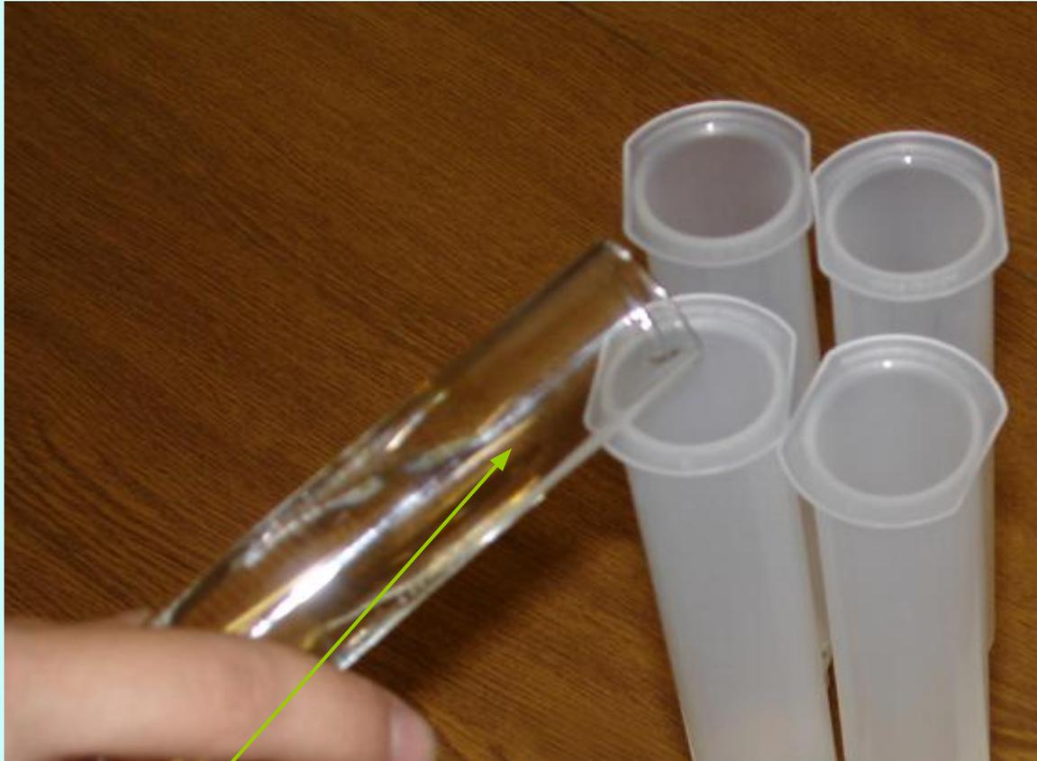
5. Из цилиндра (или другой емкости) в резервуар наливается проба.
