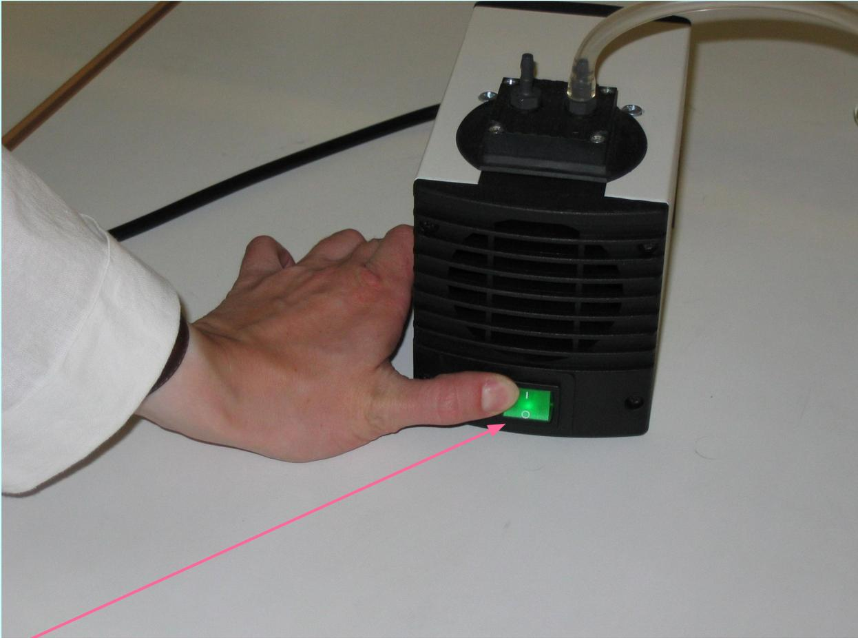
2. Включается вакуумный насос. Запорные краны при этом должны быть закрыты.
