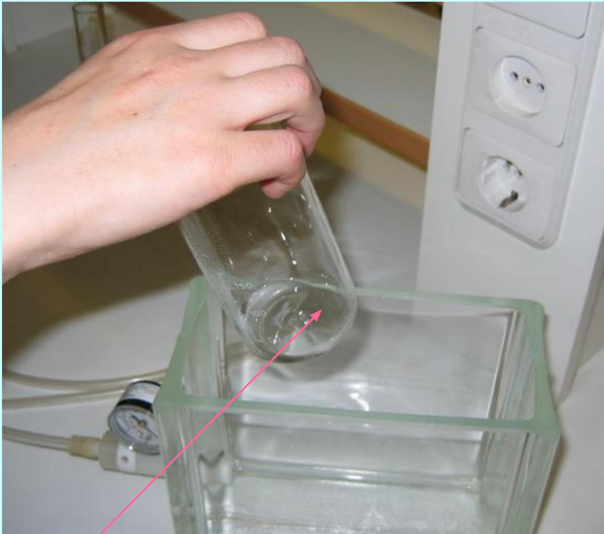
6. По окончании элюирования емкость с элюатом, содержащим целевой компонент, извлекается из камеры и направляется на ввод ВЭЖХ-системы.
