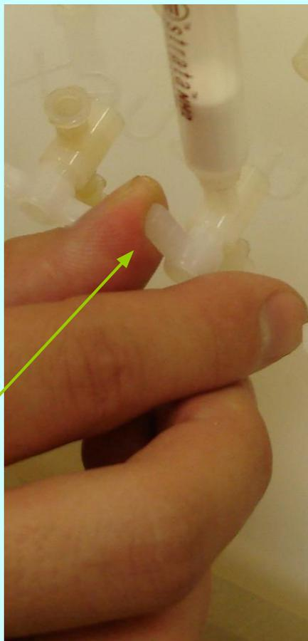
7. Запорный кран поворачивается в положение, позволяющее поддерживать нужную скорость элюирования.
