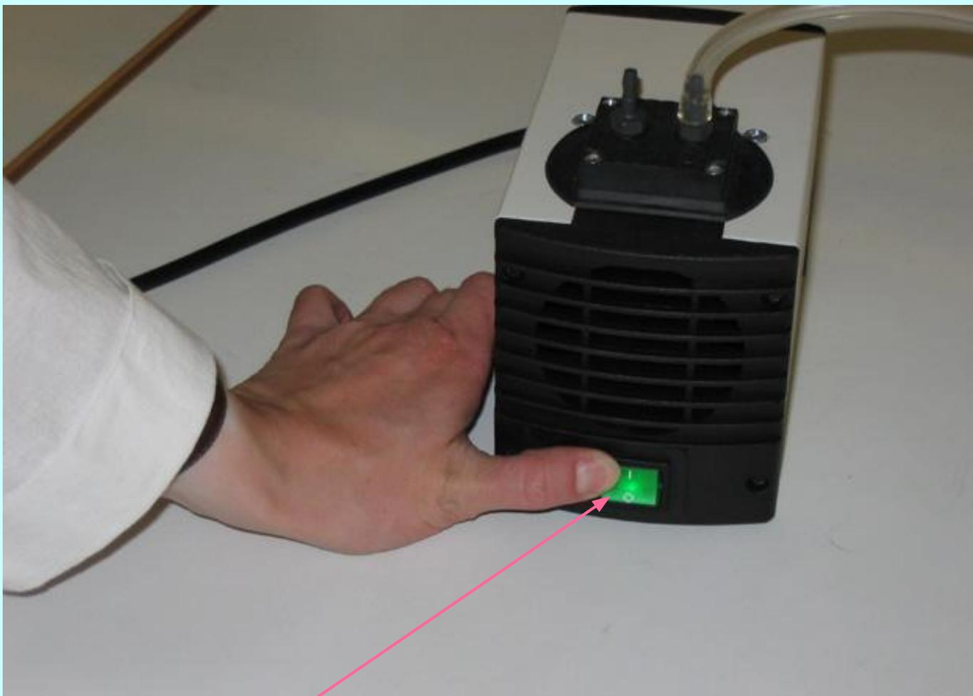
2. Включается вакуумный насос. Запорные краны при этом должны быть закрыты.
