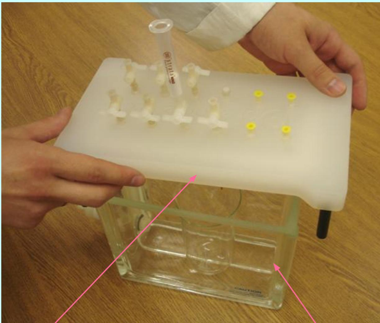
4. Крышка устройства снимается с камеры.
