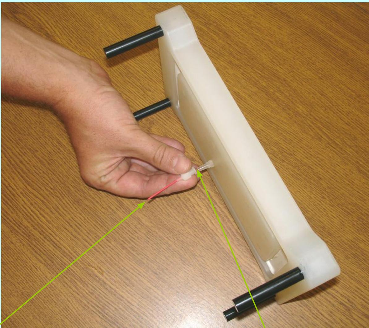
3. Игла надевается на внутренний фитинг, если этот фитинг будет задействован в процессе твердофазной экстракции.
