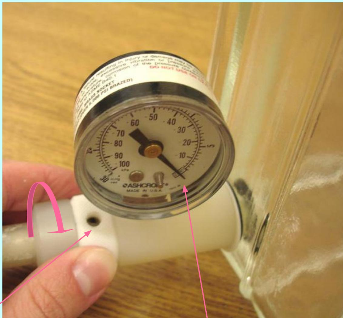
11. Вакуум в системе сбрасывают, максимально открывая отверстие вакуумной линии при помощи регулировочного вентиля.
