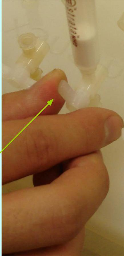
8. Запорный кран поворачивается в положение, позволяющее поддерживать нужную скорость элюирования.
