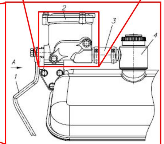
Система вентиляции картера:
