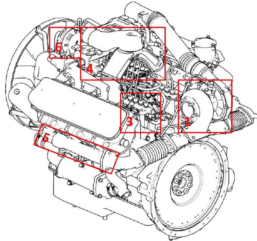
1 – турбокомпрессор, 2 – топливные фильтры, 3 – блок ТНВД, 4 – Воздушный коллектор,
