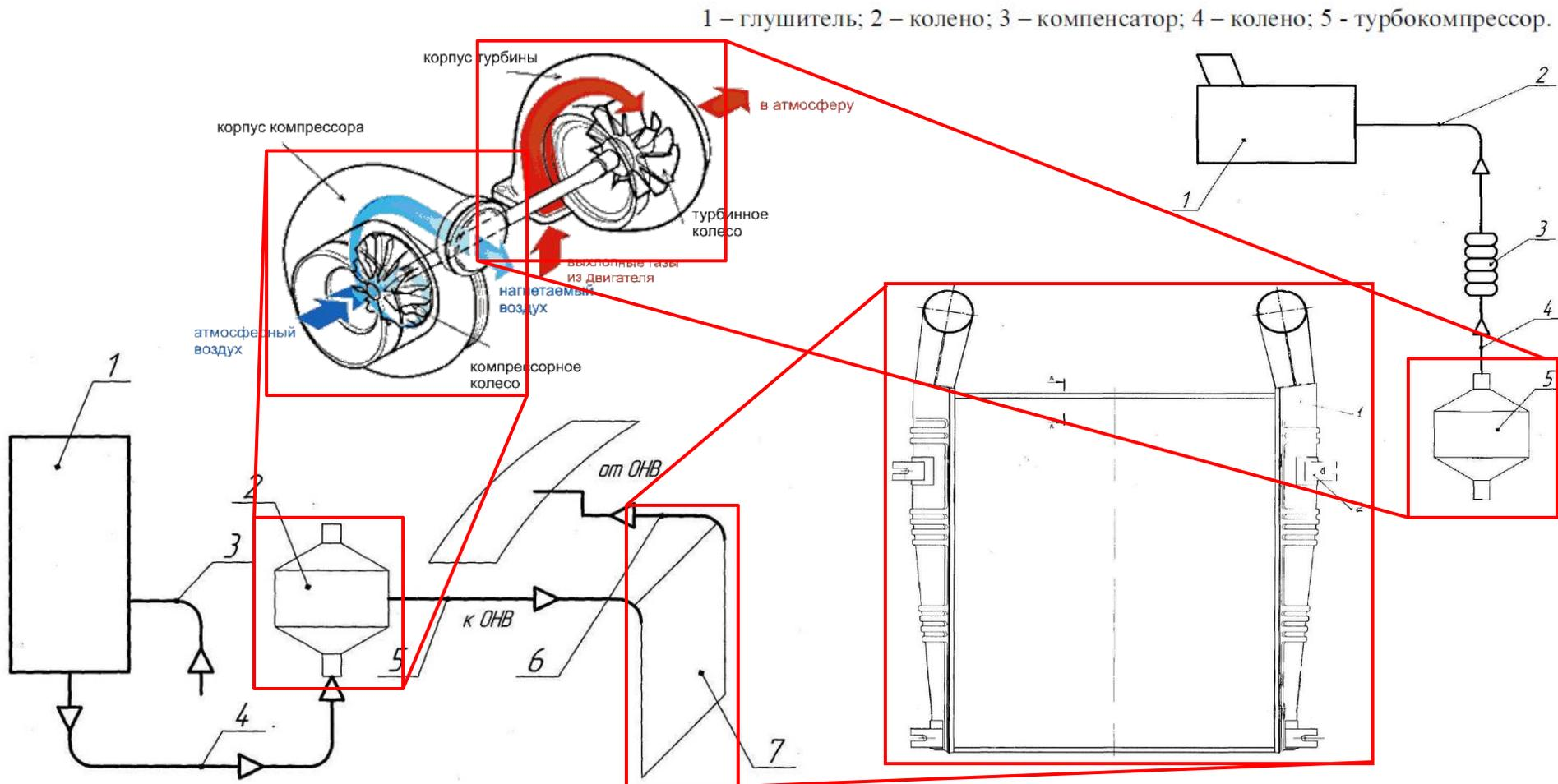
1 – фильтр; 2 – турбокомпрессор; 3 - всасывающий воздуховод;
