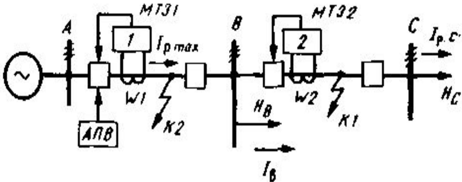
Рис.5.1. К выбору тока срабатывания МТЗ с учетом коэффициента возврата реле
