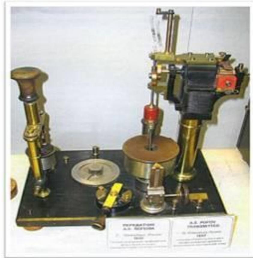
**Схема передатчика Попова** довольно проста — это **колебательный контур**, который состоит из **индуктивности** (вторичной обмотки катушки), **питаемой батареи** и **емкости** (искрового промежутка). Если нажать на ключ, то в искровом промежутке катушки проскакивает искра, вызывающая электромагнитные колебания в антенне. Антенна является открытым вибратором и излучает электромагнитные волны, которые, достигнув антенны приемной станции, возбуждают в ней электрические колебания.
