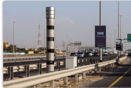
Видеозахват и контроль скорости автомобилей в Дубае (ОАЭ). Обязательная установка радио – идентификаторов на автомобиль и высокие штрафы.
