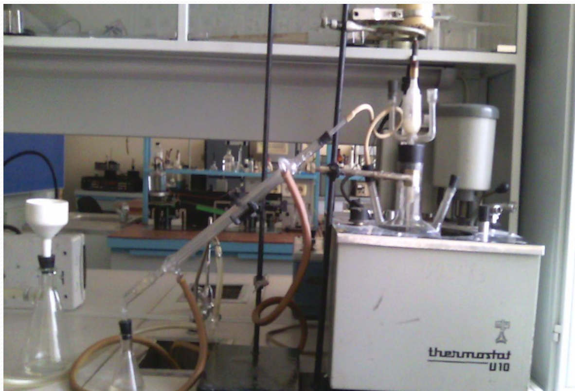
5 – сурет. Аммофоска алудың зертханалық қондырығысы
